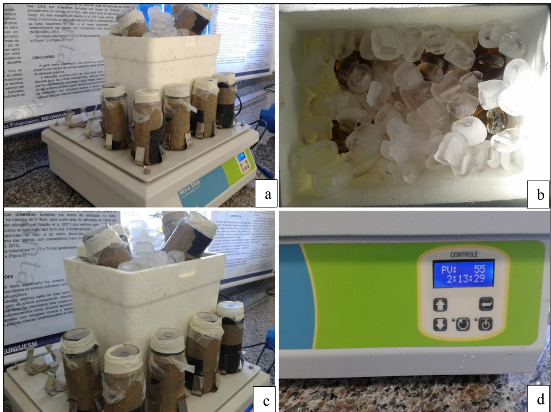
Figura 3 - Imagens do agitador de bancada com as amostras de água com e sem conservação da amostra (a; b; c). Na figura d a rotatividade do agitador para simular o transporte das amostras de água, Frederico Westphalen-RS, maio 2015.
