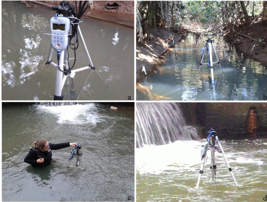
Figura 10 - Imagem parcial do local (Lajeado do Pardo) usado nas avaliações do tempo de estabilização da sonda multiparâmetros, (a e b) tempo de estabilização no regime laminar; (c e d) tempo de estabilização no regime turbulento, Frederico Westphalen, maio 2015.
