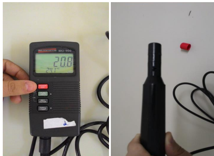
Figura 4 – Imagem do Oxímetro INSTRUTHERM MO- 900, método eletrométrico, utilizado para a determinação do Oxigênio Dissolvido em laboratório, Frederico Westphalen, maio 2015.
