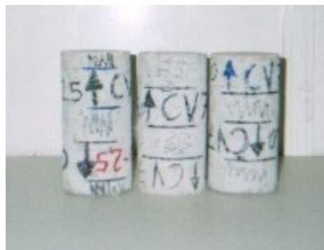
Figura 3.7: Testemunhos preparados para o corte
