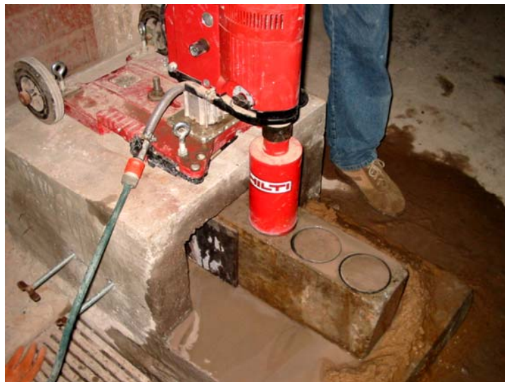
Figura 3.4: Extração dos testemunhos
