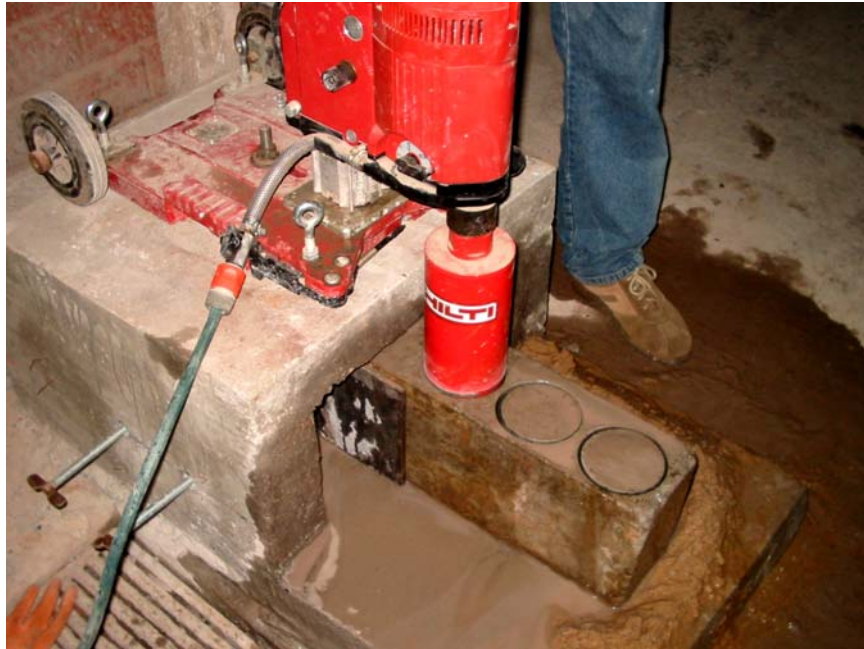
Figura 6 – Extração dos testemunhos (Petry, 2004)
