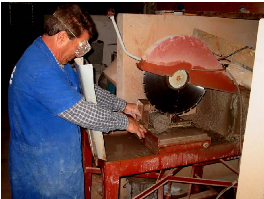
Figura 8 – Corte dos testemunhos (Petry, 2004)
