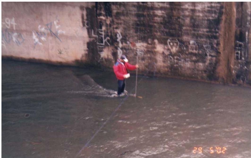
Figura 20 - Medida de vazão no canal de descarga
