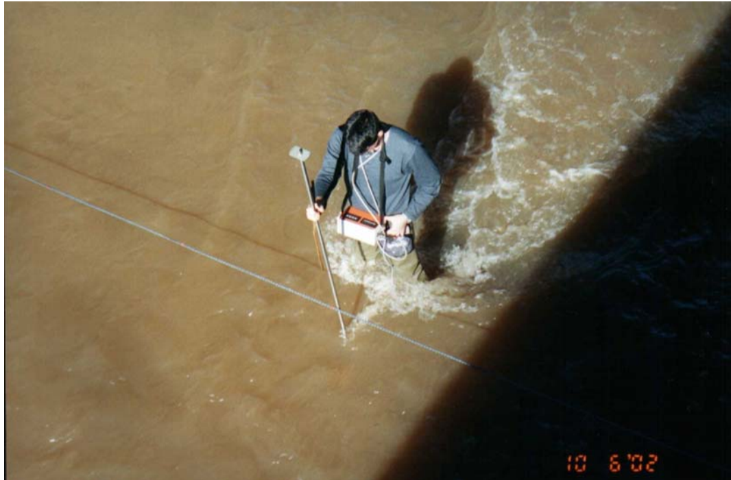
Figura 21 - Medida de vazão no canal de descarga
