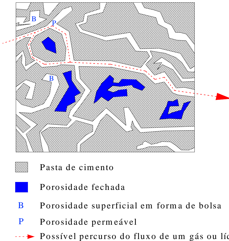
FIGURA 3 - Rede de poros da pasta de cimento (Mopt, apud Figueiredo, 1994).
