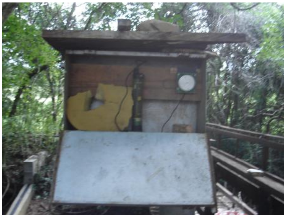
Figura 4.12 - Linígrafo eletrônico com data-logger. Utilizado(modelo Thalimedes, A-OTT)
