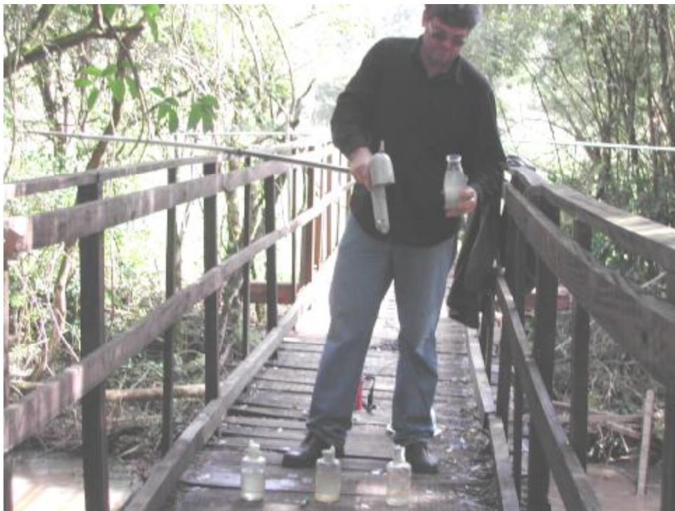
Figura 4.8 – Amostragem de sedimento na estação de jusante com o USDH-48 (AMS-1)
