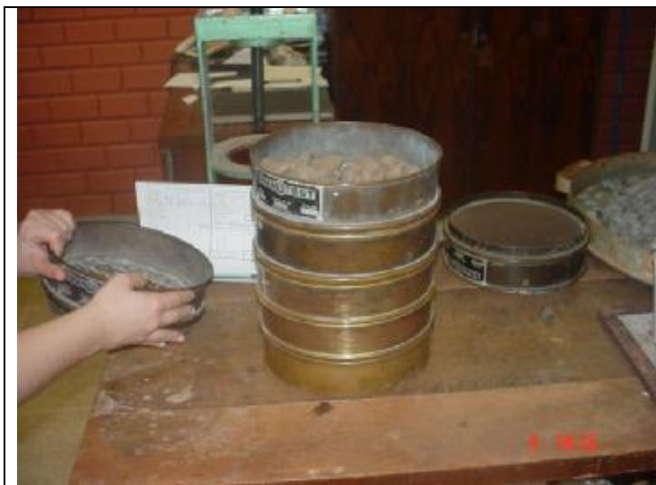
Figura 4.9 – Ensaio de granulometria realizado no laboratório da construção civil da (UFSM)
