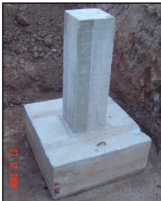
Figura 3.7 – Sapata pré-moldada utilizada nas provas de carga.
