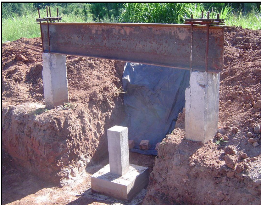
Figura 3.11 – Sapata posicionada para o ensaio S-4.
