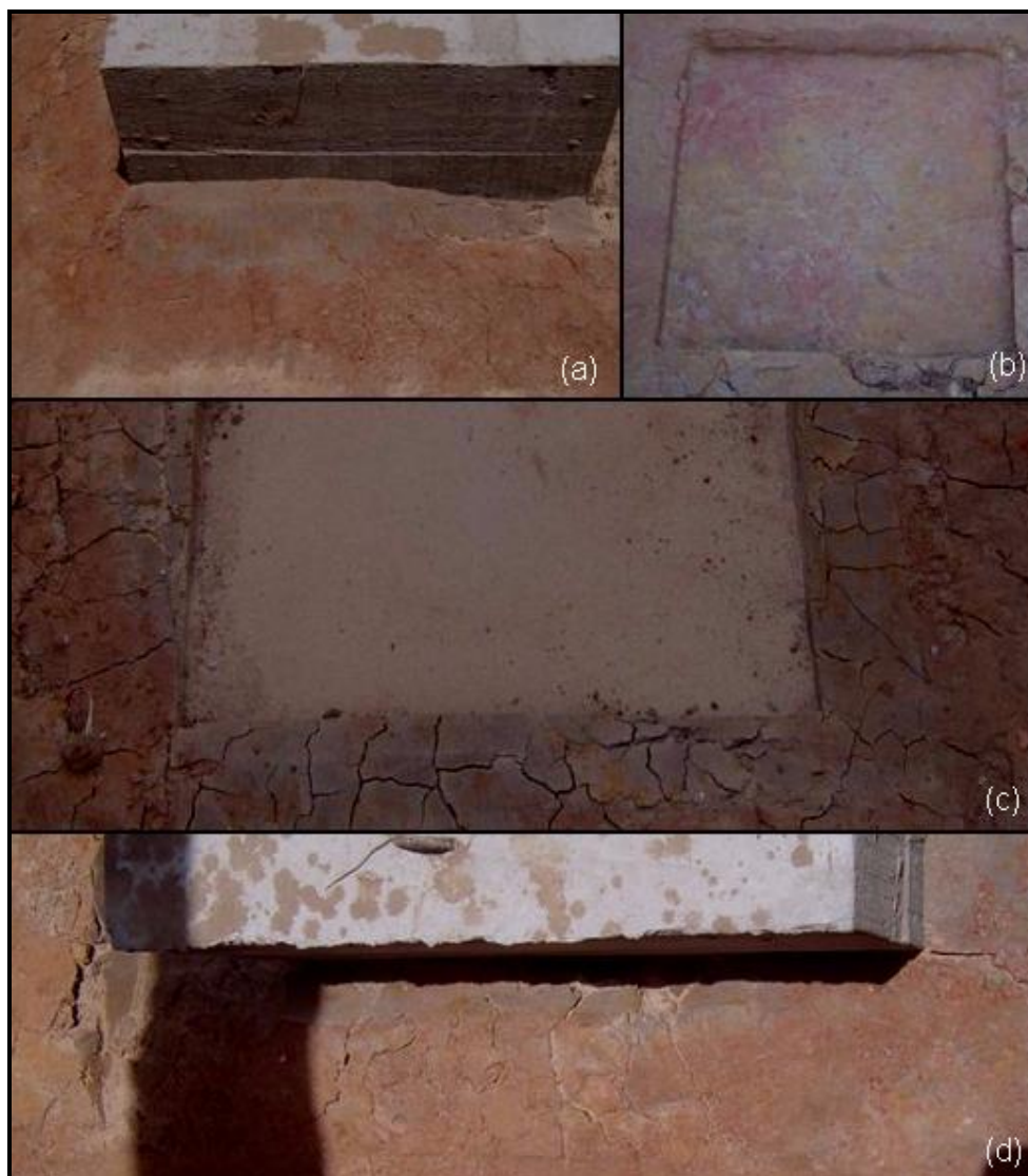
Figura 5.10 – Detalhes do comportamento do solo no entorno e abaixo da sapata.
