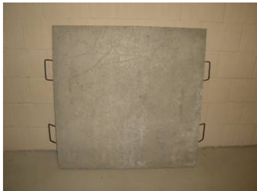
Figura 38 – Placa de argamassa sem revestimento. Espessura 4cm
