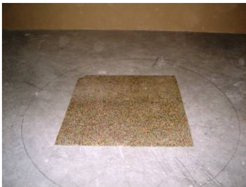
Figura 34 – Manta de densiflex. Espessura 4mm
