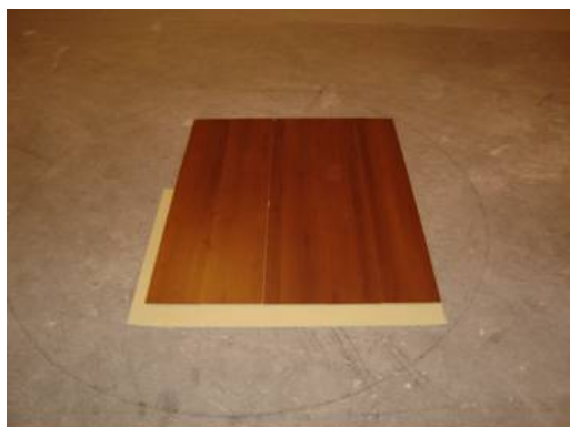
Figura 40 – Revestimento de laminado melamínico de madeira, espessura 7,0mm, assentado sobre a manta de espuma de polietileno de 2,0mm de espessura
