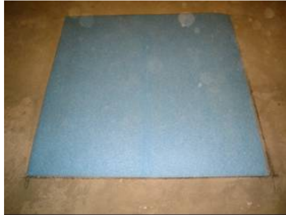
Figura 37 – Manta de espuma de polietileno. Densidade 27,0 kg/m 3 . Stratocell.
