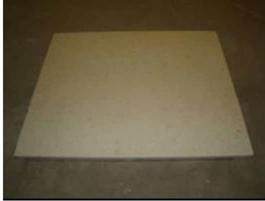
Figura 35 – Placa de poliestireno expandido densidade 27,5kg/m 3 - Isopor VI
