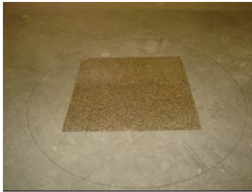
Figura 33 – Manta de rubberflex. Espessura 8mm
