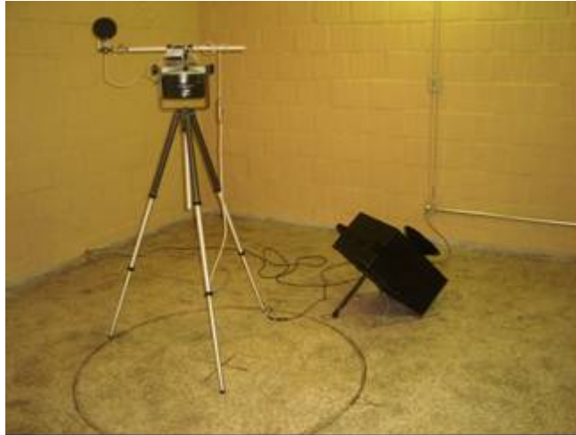
Figura 42 – Colocação dos equipamentos na câmara de recepção
