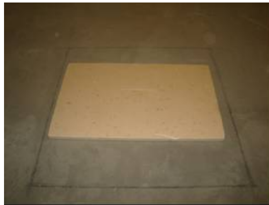
Figura 36 – Placa de poliestireno expandido. Densidade 32,5kg/m 3 . Isofoan
