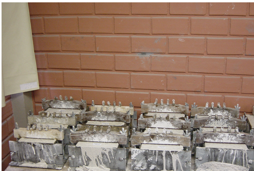
Figura 4.3. Corpos-de-prova prismáticos para ensaio de resistividade elétrica.
