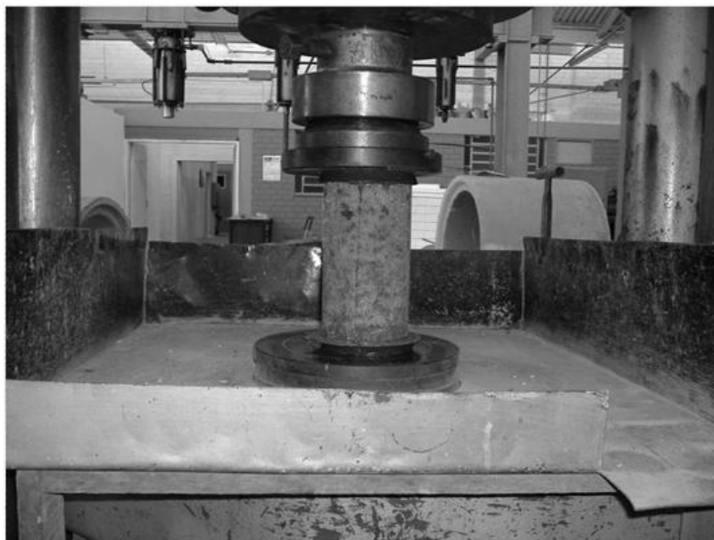
Figura 4.5 – Prensa hidráulica para ensaio de ruptura de corpos de prova à compressão axial.
