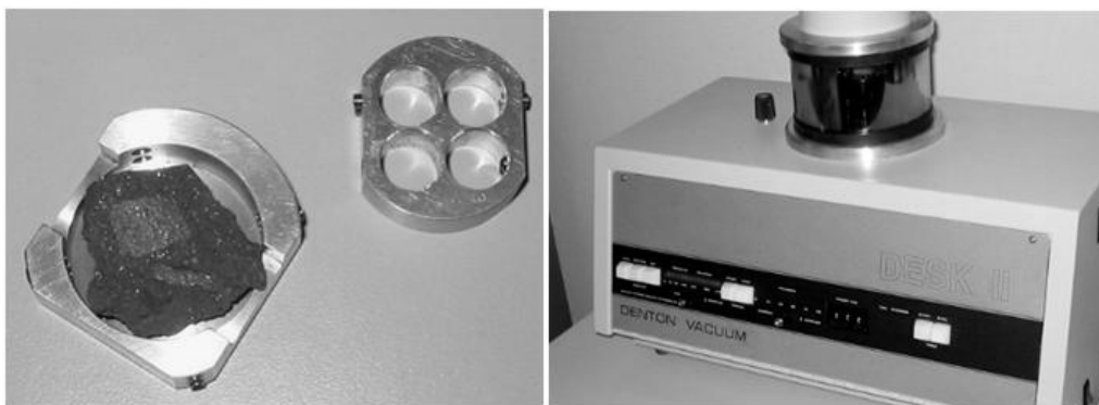
Figura 4.8 – Amostra de fragmento de concreto e equipamento de vácuo.
