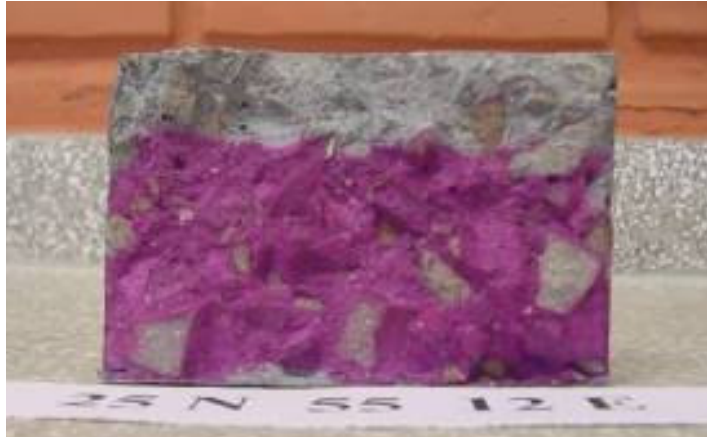
Figura 4.16 – Detalhe do corpo-de-prova após a aspersão de fenolftaleína
