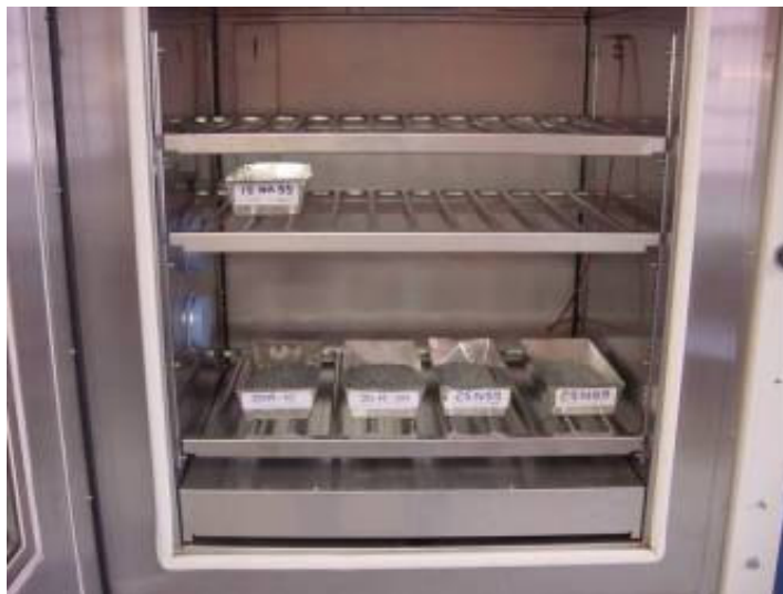
Figura 4.6 – Câmara climática FEUTRON – detalhe do interior
