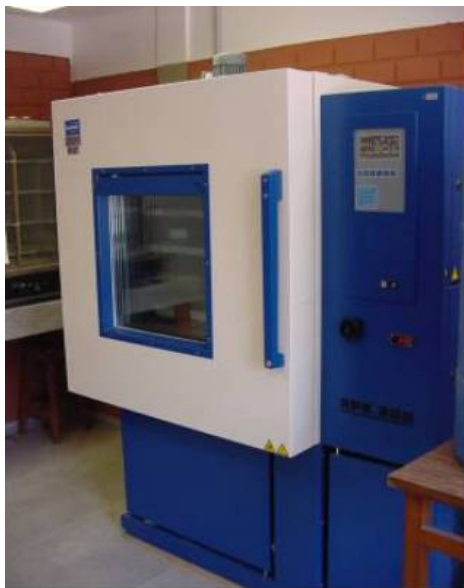
Figura 4.5 – Câmara climática FEUTRON MODELO KPK 200
