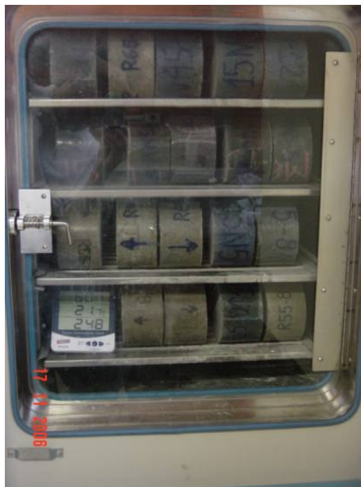
Figura 4.13 – Detalhe da câmara de carbonatação FANEM – 345.
