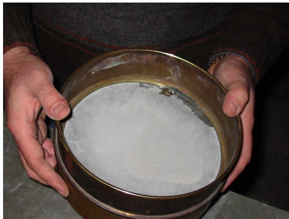
Figura 4.20 – Pó peneirado na peneira de malha #200
