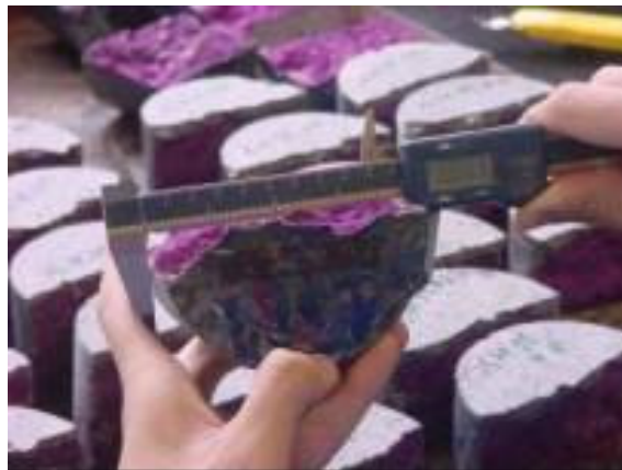
Figura 4.17 – Detalhe da obtenção das medidas do corpo-de-prova
