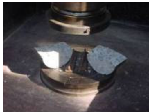
Figura 4.15 - Detalhe do cp depois da ruptura
