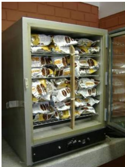
Figura 4.12 – Estufa para a redistribuição da umidade (50°C)
