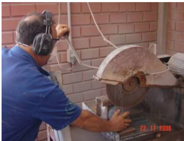
Figura 4.4 – Corte dos corpos-de-prova
