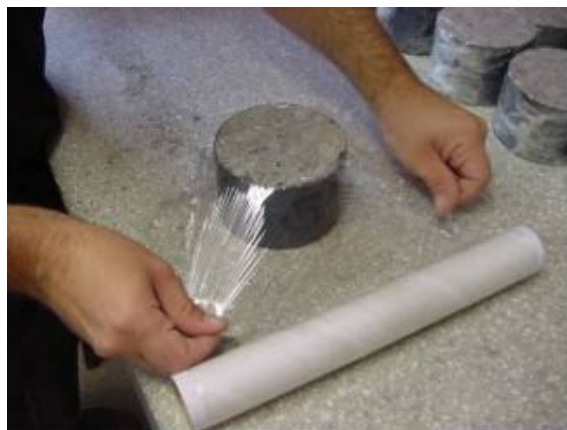
Figura 4.8 – Colocação do filme de polietileno
