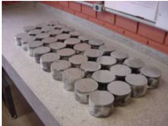
Figura 4.9 – Corpos-de-prova com filme de polietileno
