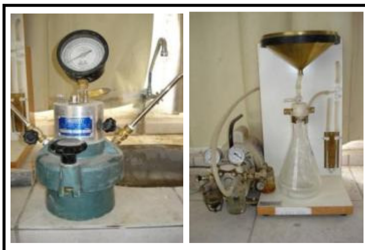
Figura 20 – Equipamentos: ar incorporado e retenção de água
