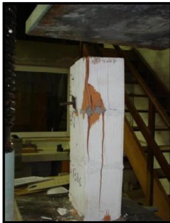
Figura E14: prisma de 3 blocos T4 BPV
