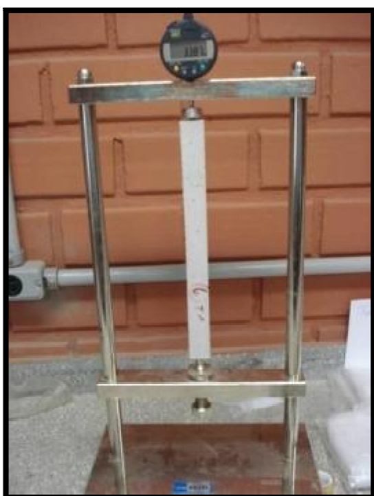
Figura 19 – Equipamento de expansão ou retração linear
