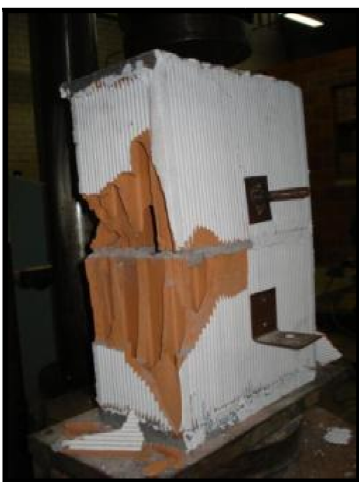
Figura E3: Prisma de 2 blocos T2 BPV
