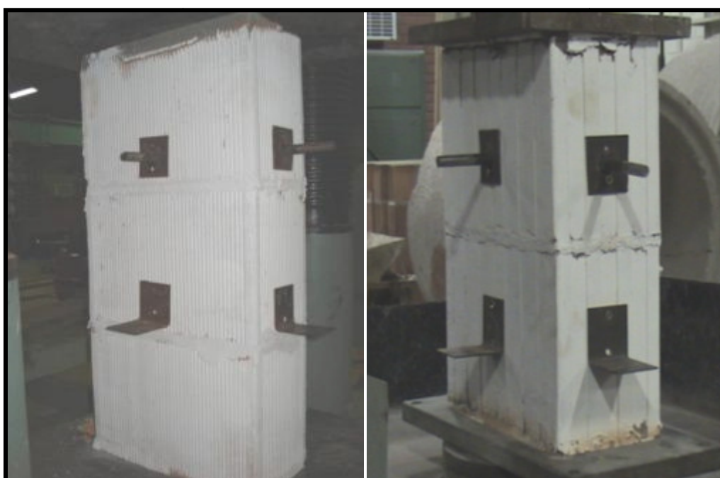
Figura 25 – Ensaio à compressão dos prismas
