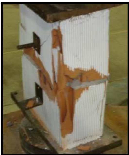
Figura E5: Prisma de 2 blocos T3 BPV
