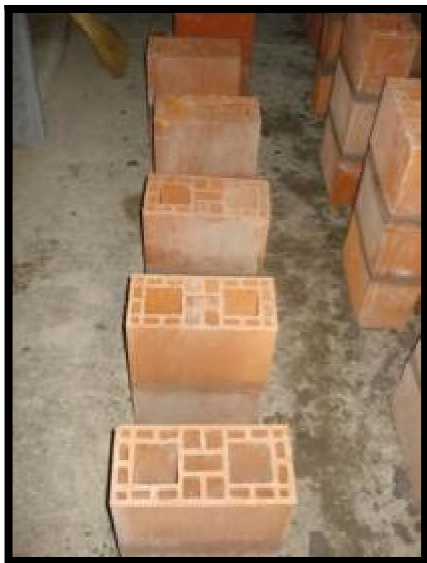
Figura 23 – Moldagem dos prismas
