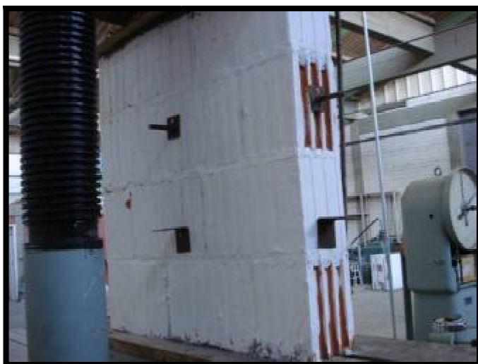
Figura 28 – Ensaio das pequenas paredes
