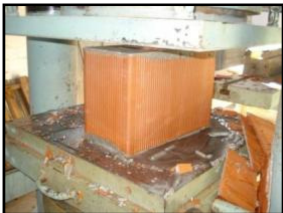
Figura 16 – Ensaio de compressão dos blocos
