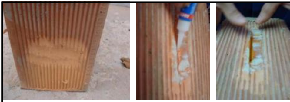
Figura 17 – Fixação dos extensômetros elétricos nos blocos
