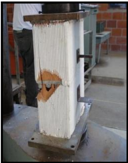
Figura E1: Prisma de 2 blocos T1 BPV
