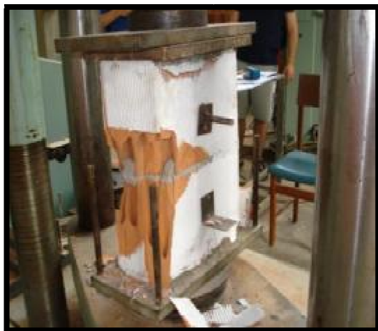
Figura E7: Prisma de 2 blocos T4 BPV
