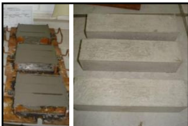
Figura 21 – Corpos-de-prova de argamassa
