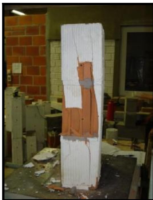
Figura E12: Prisma de 3 blocos T3 BPV
