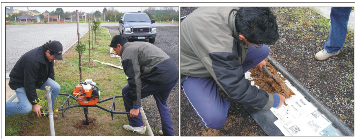
Figura 3.8 – Execução do furo com trado mecânico e coleta de material. Fonte: Trabalho de campo (2007).
