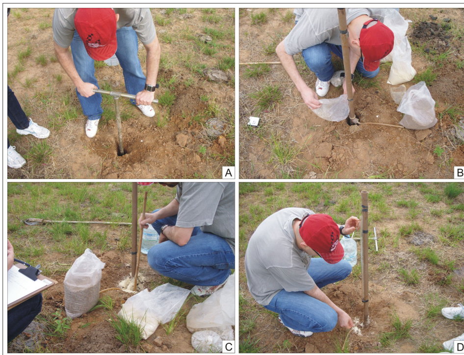
Figura 3.5 – Etapas da execução do ensaio de k com piezômetro escavado. Fonte: Trabalho de campo (2008).
