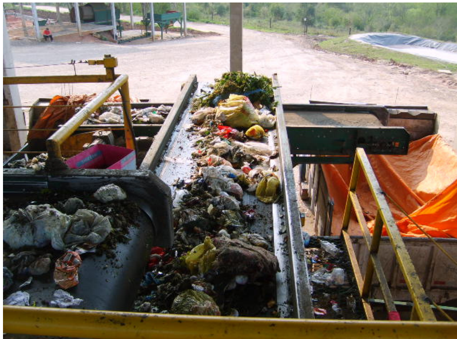
Figura 4.8 – Rejeito transportado em esteiras para abastecer caminhões de transporte para o Aterro Sanitário
