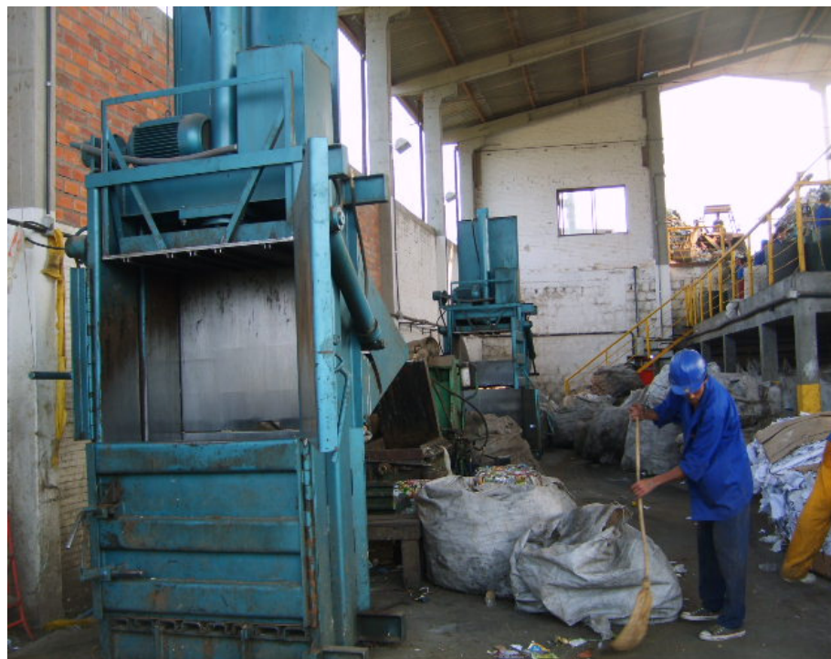
Figura 3.2– Prensa vertical utilizada para compactar rejeito.
