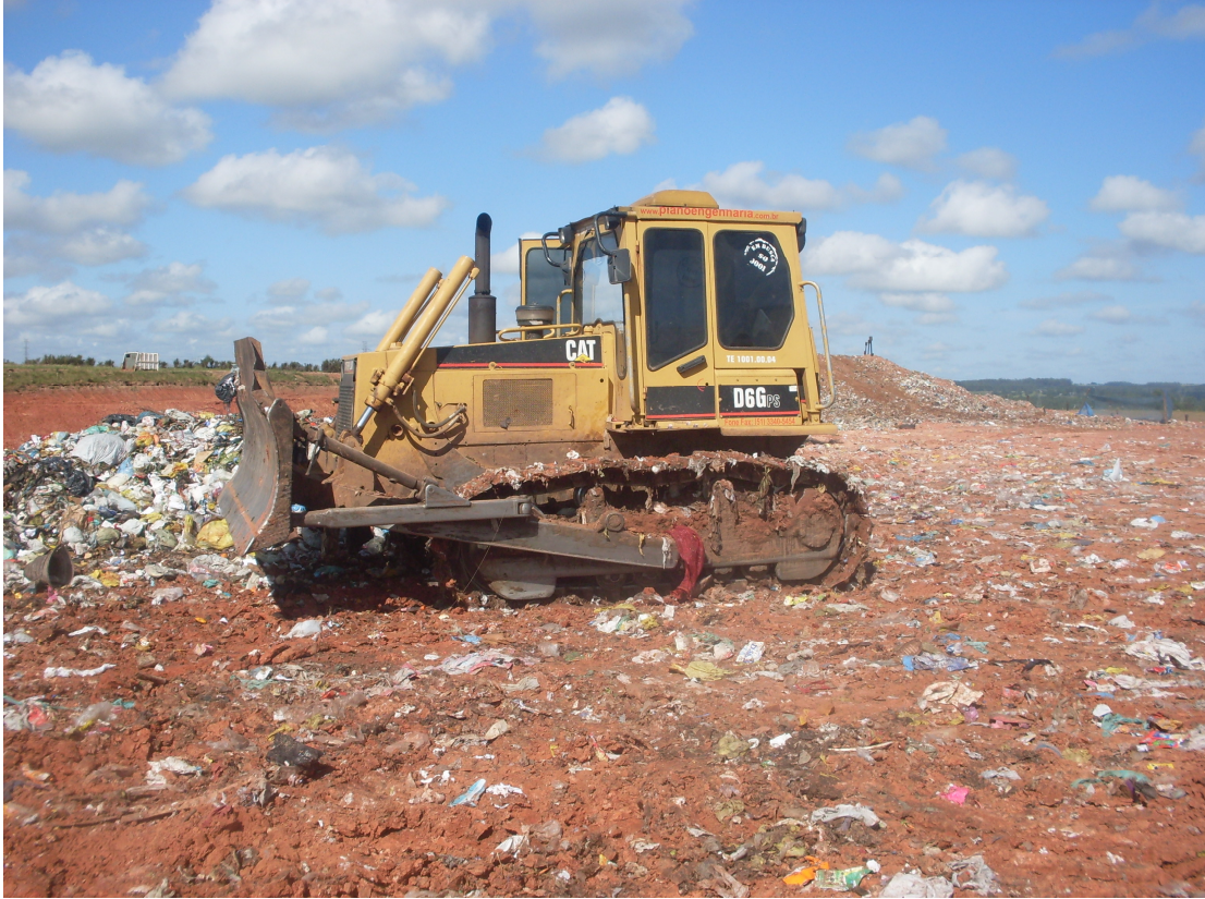
Figura 5.23 – Trator de Esteira – D6G.
