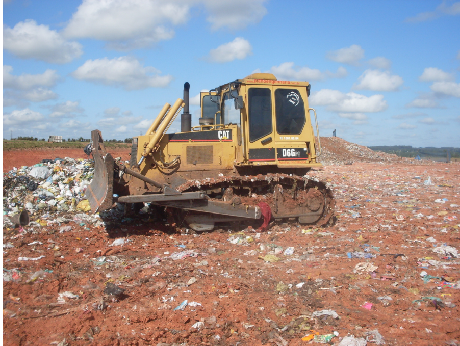
Figura 3.1 – Equipamento Utilizado atualmente para compactação de resíduos – Trator de esteira – modelo D6G
