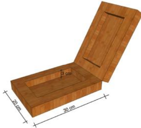
Figura 18: detalhes do dispositivo de madeira (fonte impulsiva)
