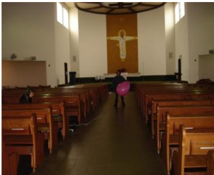
Figura 17: medição realizada com o emprego de balão
