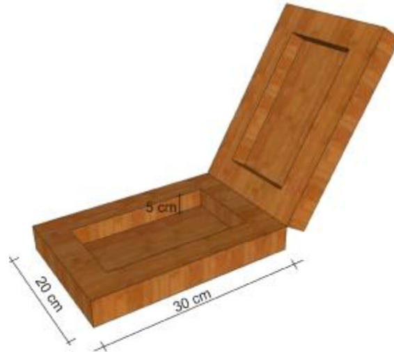
Figura 25: detalhes do dispositivo de madeira (fonte impulsiva)
