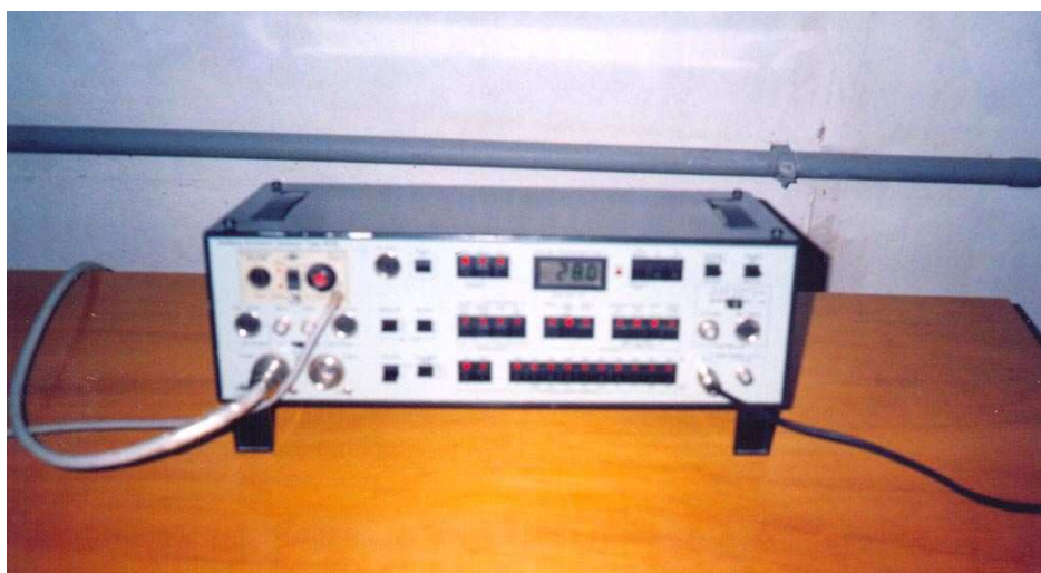
FIGURA 76 – Equipamentos utilizados nos ensaios (analisador acústico).
