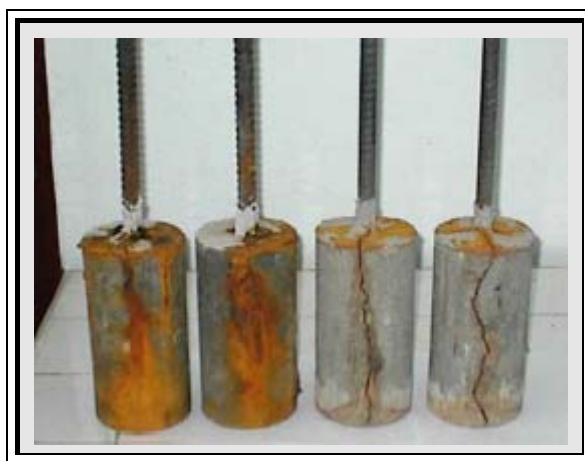
Figura 2.10 – Corpos-de-prova após ensaio de corrosão acelerada em solução com 4% de cloreto de sódio (GÜNEYISI et al , 2005).
