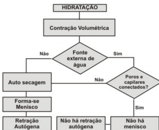
Figura 2.1: Influência das condições de cura na ocorrência da retração autógena – adaptado de AİTCIN (2003).
