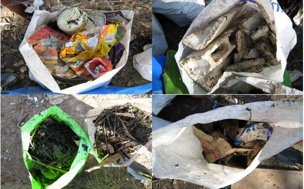
Figura 23 - Separação de alguns RSD em sacos plásticos, conforme o padrão de cores utilizado no trabalho: (a) plástico (vermelho); (b) isopor (verde B); (c) matéria orgânica (marrom B) e (c) papel e papelão (azul).
