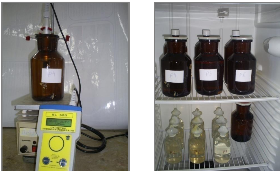
Figura 12 – Leitura da concentração de oxigênio dissolvido e amostras no interior da incubadora
