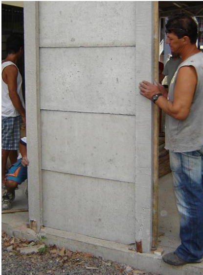
Figura 04 – Preparação das placas para os ensaios de impacto realizado no laboratório.
