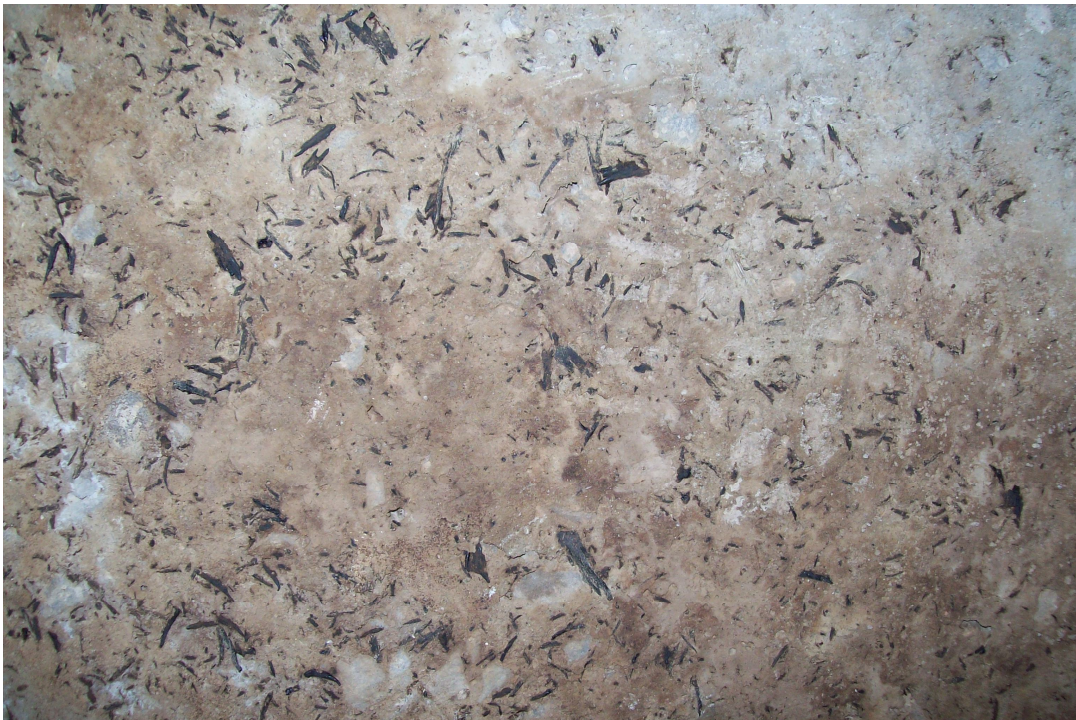
Figura 53 – Detalhe da vista externa da placa de 3 cm do segundo ensaio (aquecimento até 682,3°C): mostrando a modificação das partículas superficiais.
