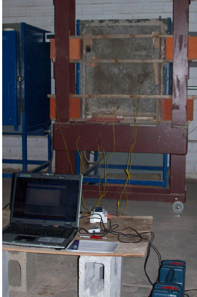
Figura 17 – Montagem final da placa no pórtico, junto os termopares e captação dos dados para realização do ensaio.
