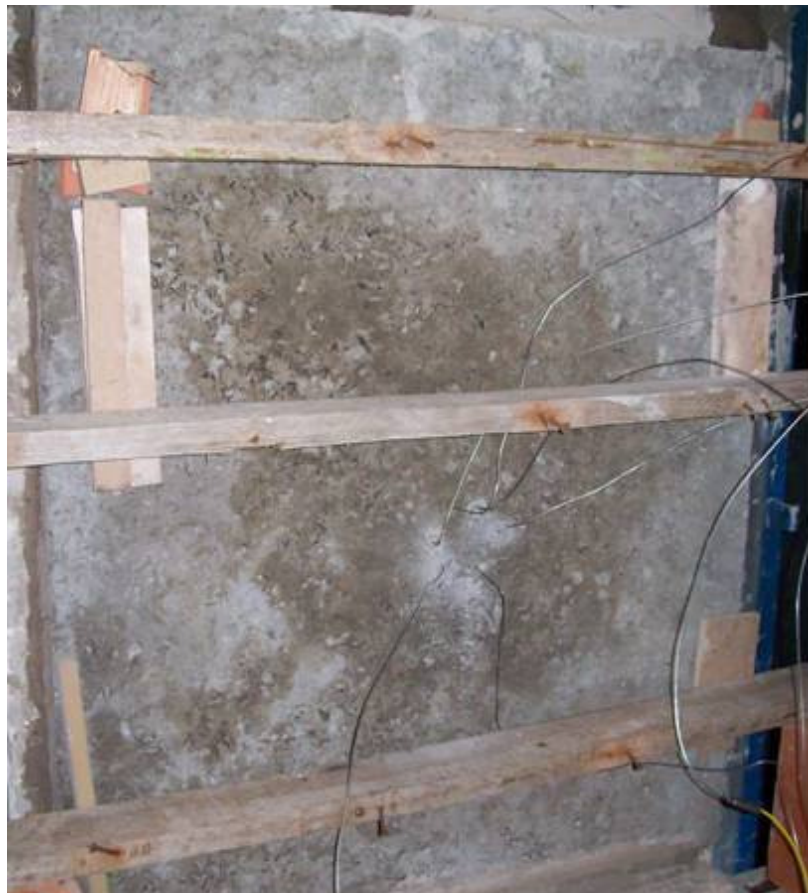
Figura 49 – Vista externa da placa de 5 cm do segundo ensaio (aquecimento até 800°C): apresenta manchas fracas no centro da placa.
