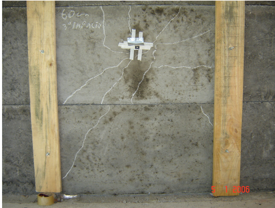
Figura 34 – Detalhes das placas sob ensaio de impacto de corpo mole
