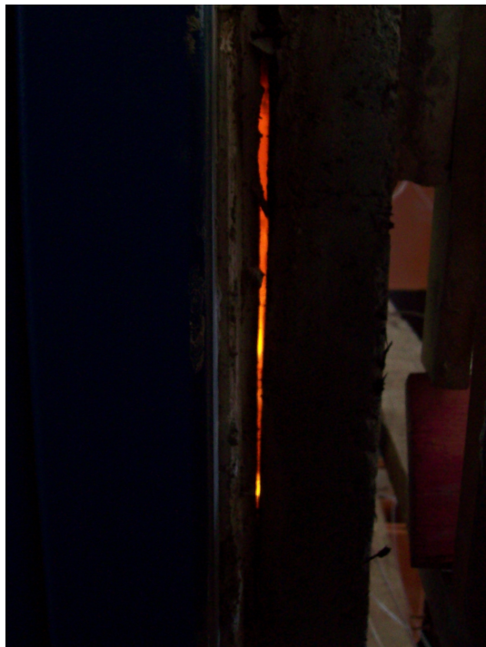
Figura 48 – Vista lateral superior mostrando parte superior da placa de 3 cm e formação da fresta entre placa e o forno; a cor vermelho indica o processo de incêndios dentro do forno.
