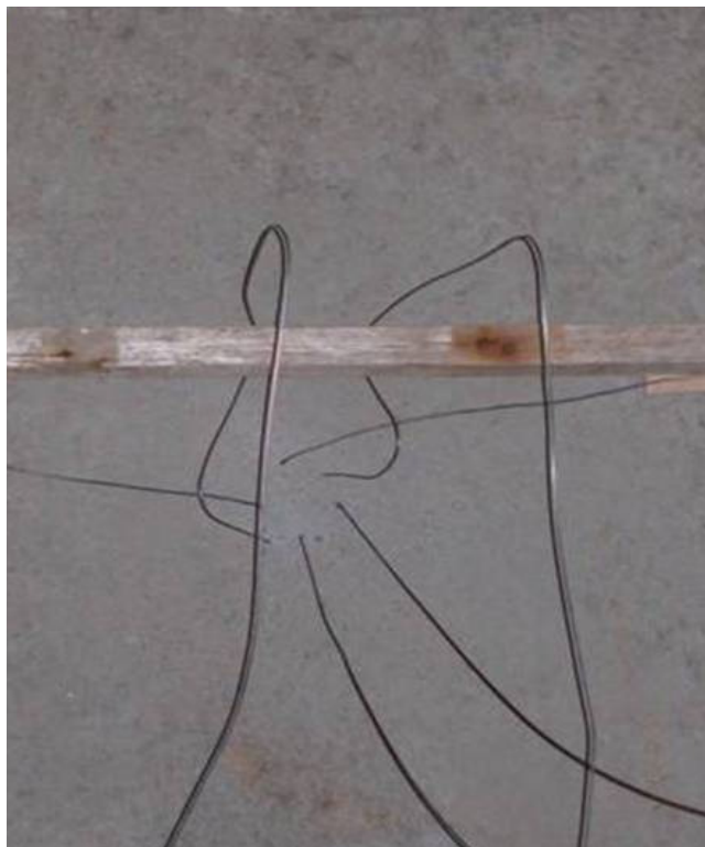
Figura 18 – Agrupamento dos Termopares: 2 na face interna, 2 na externa e 2 no meio da placa
