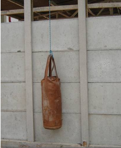
Figura 08 – Saco cilíndrico de couro preenchido com areia, 40kg frente a estrutura para realização dos ensaios no laboratório.
