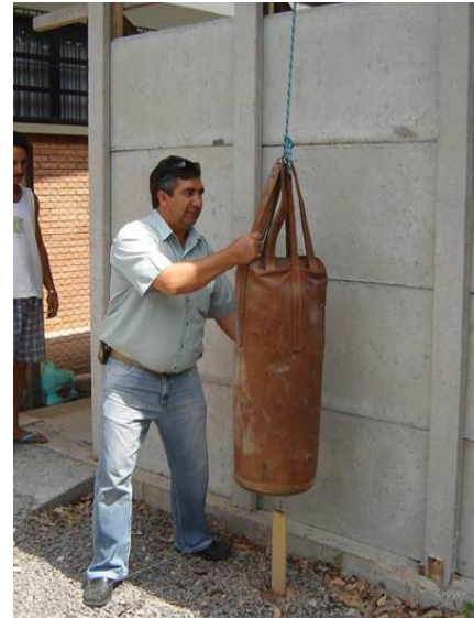
Figura 05 – Ensaio de corpo mole realizado no laboratório.
