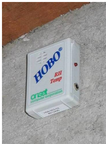
Figura 14 – Datalogger (HOBO) utilizado nos ensaios.
