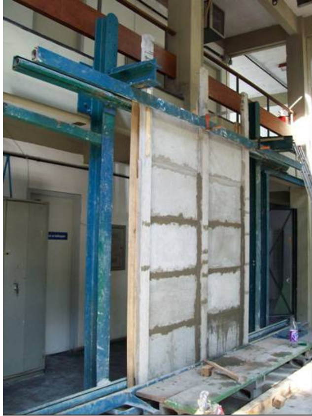
Figura 12 – Parede montada para ensaio
