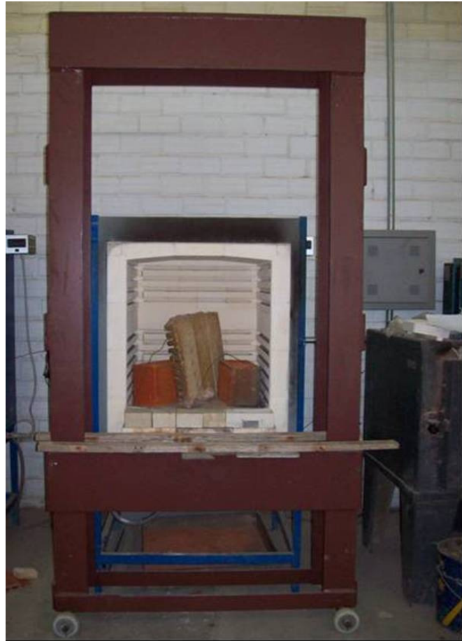
Figura 15 – Vista frontal do forno com pórtico para o ensaio.
