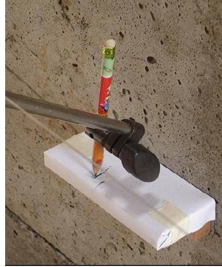
Figura 09 – Marcador do deslocamento residual.
