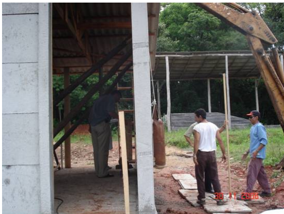
Figura 06 – Ensaio de corpo mole realizado no protótipo.
