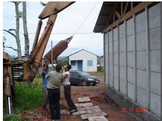
Figura 07 – Ensaio de corpo mole realizado no protótipo.
