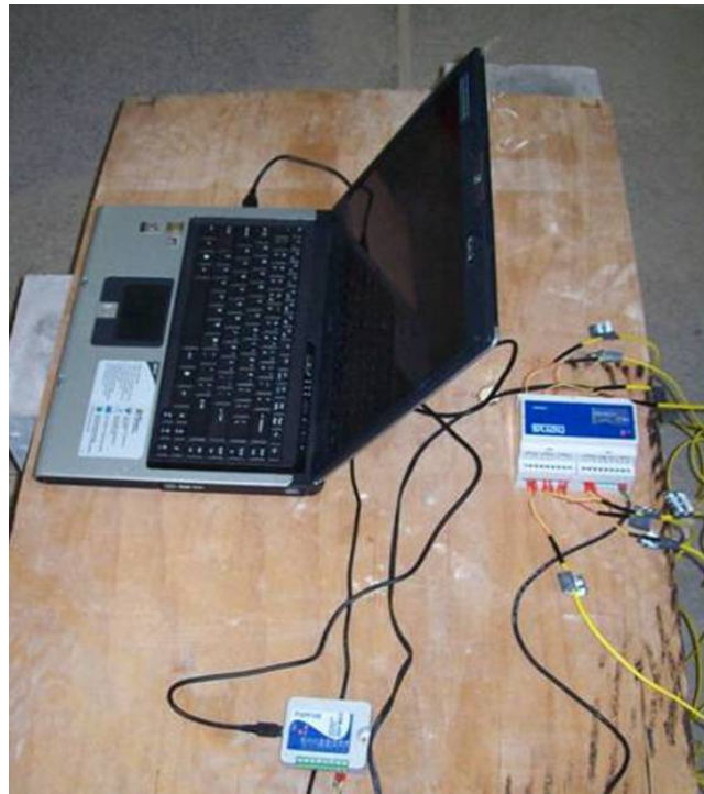
Figura 16 – Captação dos dados online via Datalogger conectado ao computador.
