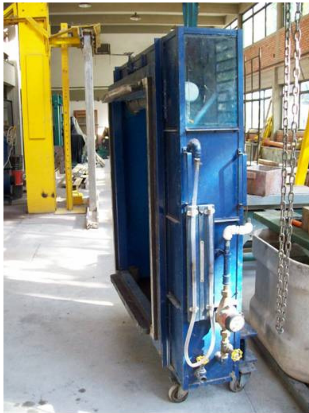
Figura 13 – Aparelho para ensaio de estanquidade.
