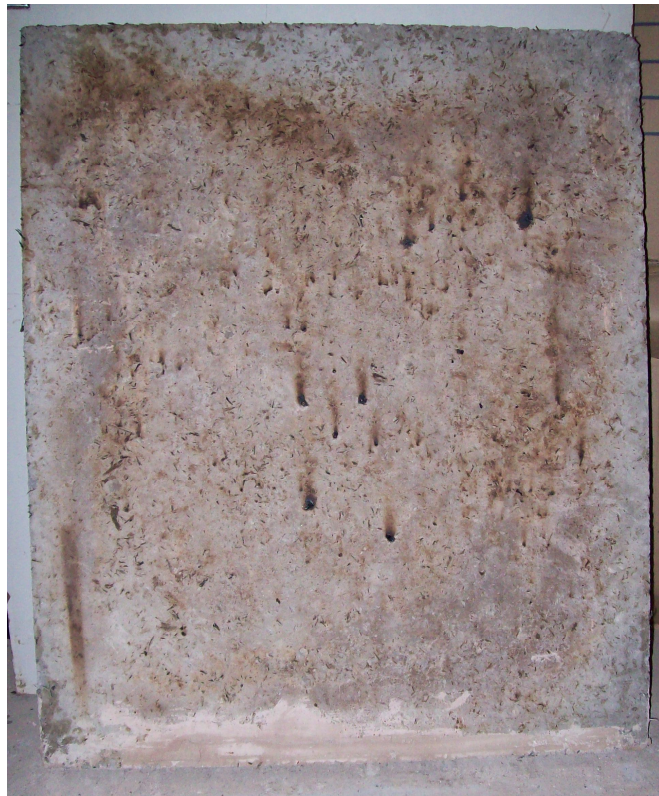
Figura 52 – Vista interna da placa de 3 cm, após o ensaio: visível as marcas marrom escuras, principalmente na parte superior da placa.
