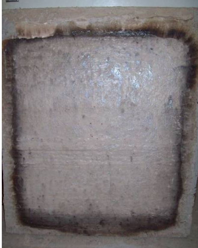
Figura 51 – Vista interna da placa de 5 cm, após o ensaio: visível as marcas escuras nas bordas da placa provocadas pela saída dos gases e a cor acinzentada no centro.
