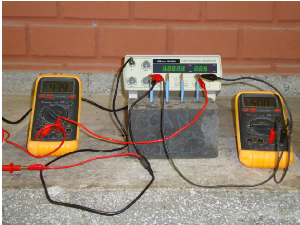
Figura 4.4 - Ensaio de resistividade elétrica sendo executado.
