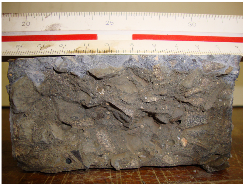
Figura 4.6 – Corpo de prova do ensaio ASTM C1202:2005 após a aspersão da solução de nitrato de prata.
