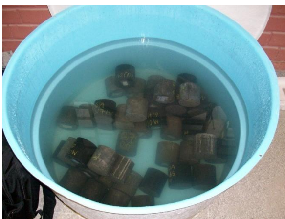
Figura 100 - Corpos de prova imersos em solução salina.
