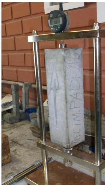
Figura 98 - Aparelho medidor do comprimento dos prismas.
