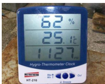
Figura 93 - Aparelho usado no controle da climatização da sala de leitura.
