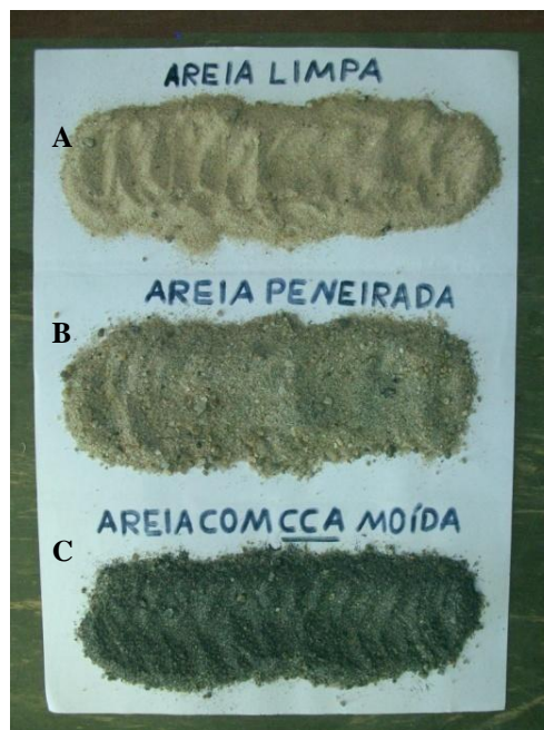
Figura 15 - Areia limpa (A), areia após peneiramento (B) e areia com CCA moída (C)
