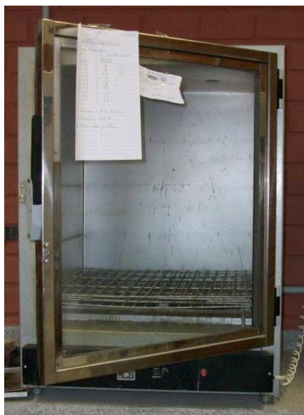
Figura 90 - Estufa empregada no acondicionamento dos recipientes.
