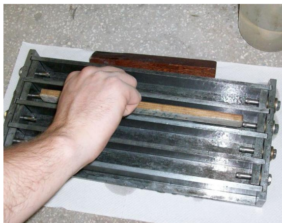
Figura 87 - Conferência do comprimento efetivo de medida na forma das barras de argamassa.
