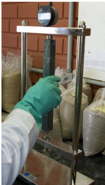
Figura 91 - Aparelho usado como medidor do comprimento das barras.
