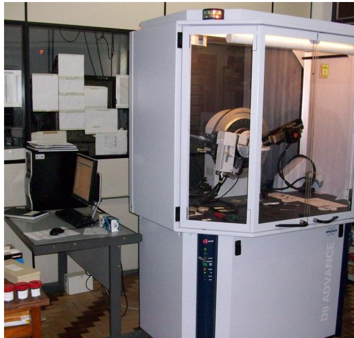
Figura 97 - Equipamento de DRX usado na investigação.
