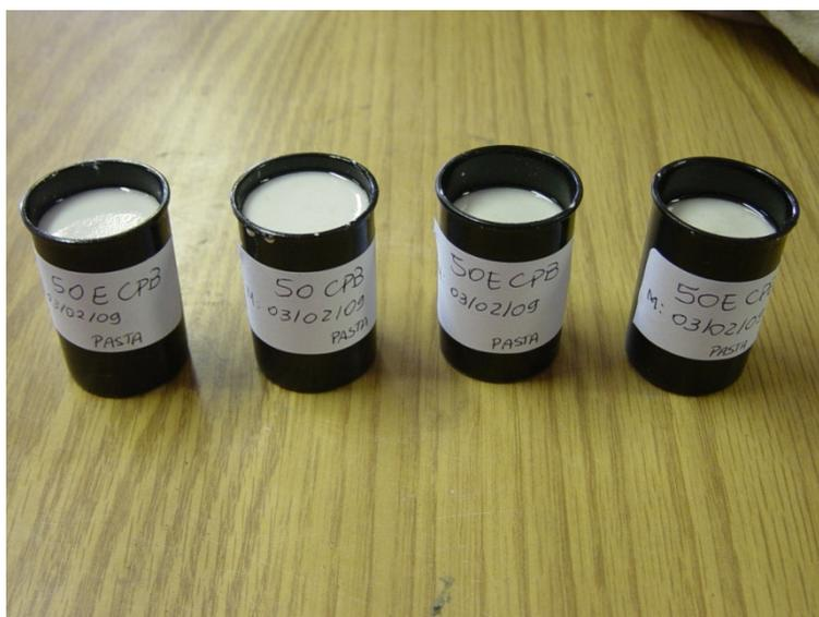
Figura 39 – Moldagem dos corpos-de-prova de pasta
