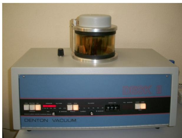
Figura 42 – Equipamento para metalização das amostras para análise no MEV.
