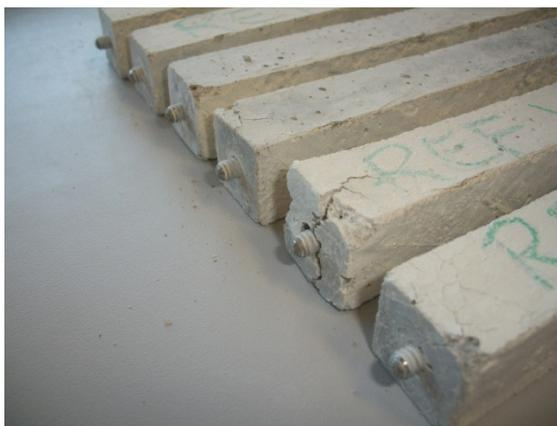
Figura 45 – Barras de argamassa da mistura REFV. Observa-se o colapso de uma das barras, que impossibilitou a realização da sua leitura aos 24 meses devido ao pino ter se soltado.
