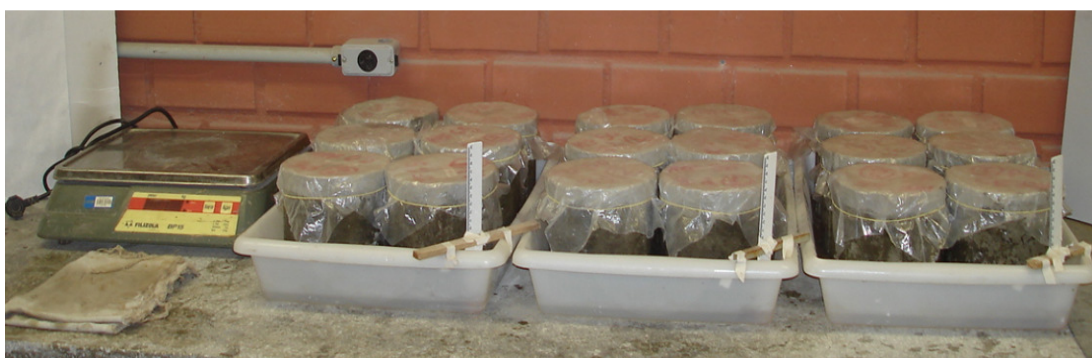
Figura 3.11 – Corpos-de-prova posicionados sobre suportes dentro de recipientes com nível de água constante.
