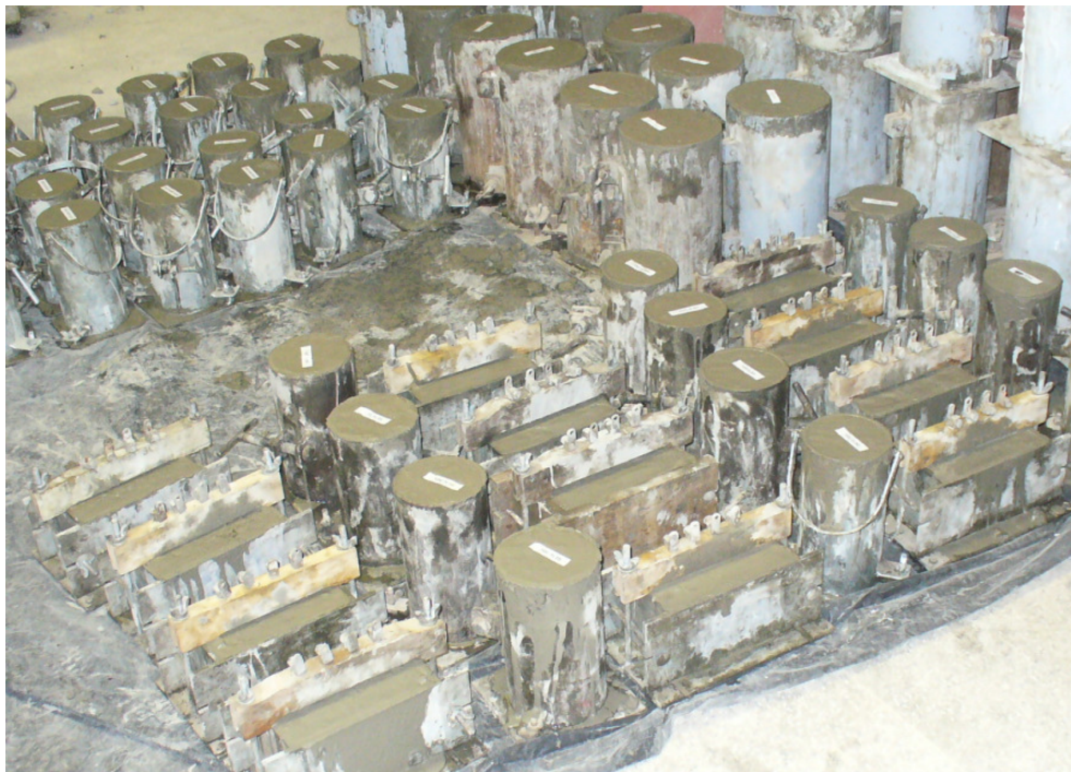
Figura 3.8 – Corpos-de-prova moldados para os ensaios de resistência à compressão axial, de absorção capilar e de resistividade elétrica aparente.
