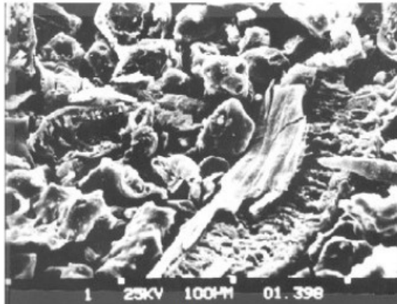
Figura 2.17 – Micrografia de CCA produzida em forno comum (AGOPYAN, 1991 apud POUEY, 2006, p. 26).
