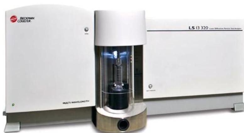
Figura 40: LS 13 320 MW - analisador de tamanho de partícula (granulômetro) por difração a laser.
