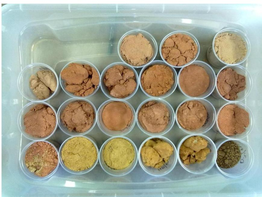
Figura 39: Amostras de calha do poço de monitoramento CAC 03.
