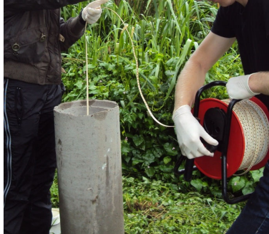
Figura 27 - Medição de nível de água subterrânea no poço PM-01.
