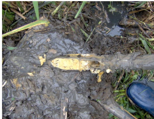
Figura 9 - Sondagem investigativa a partir de perfuração manual, amostra do solo encontrado na profundidade de 3 metros aproximadamente.
