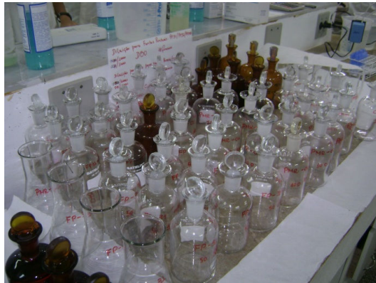
Figura 15 - Vidraria para análise de DBO (Demanda Bioquímica de Oxigênio) no laboratório LASAM.
