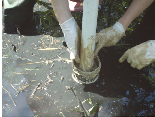
Figura 12 - Preenchimento com bentonita para fixação do poço.
