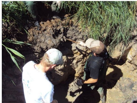
Figura 32 - Abertura da Trincheira 2 para a caracterização do solo e coleta de amostras.
