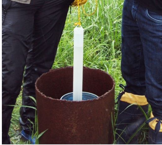
Figura 30 - Coleta de amostra de água subterrânea no poço PB-17 utilizando-se amostrador tipo bailer .
