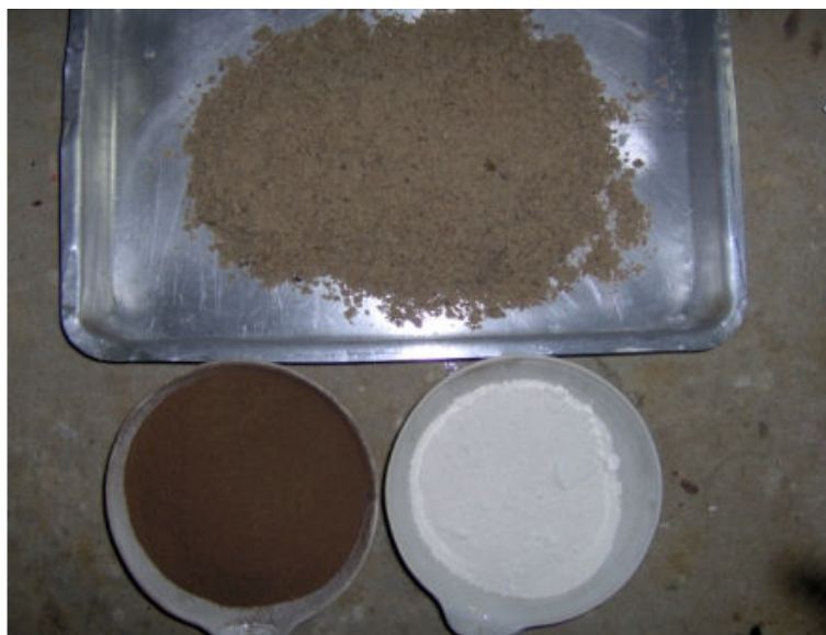
Figura 2: Preparação do ensaio: Solo controle - 70% de areia, 20% de caulim e 10% de Sphagnum .
