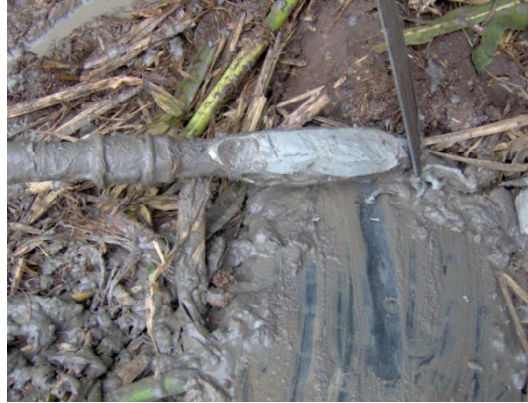
Figura 8 - Sondagem investigativa a partir de perfuração manual com trado tipo holandês de 2" de diâmetro, amostra de solo entre 1,00 a 1,50 metros de profundidade.
