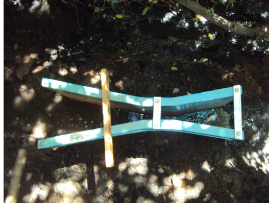
Figura 18 - Medição de vazão com calha Parshall no ponto FP 31A, vista superior.
