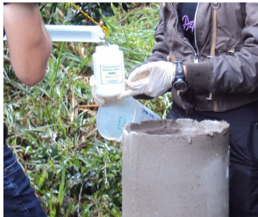
Figura 28 - Coleta de amostra de água subterrânea PM-02.
