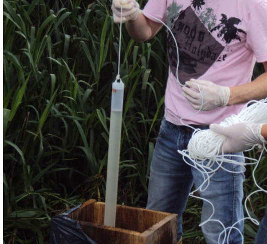
Figura 25 - Procedimento de amostragem, coleta de água no poço de monitoramento raso PMR-01.
