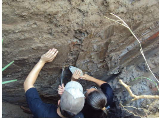
Figura 31 - Abertura da Trincheira para a caracterização do solo e coleta de amostras.
