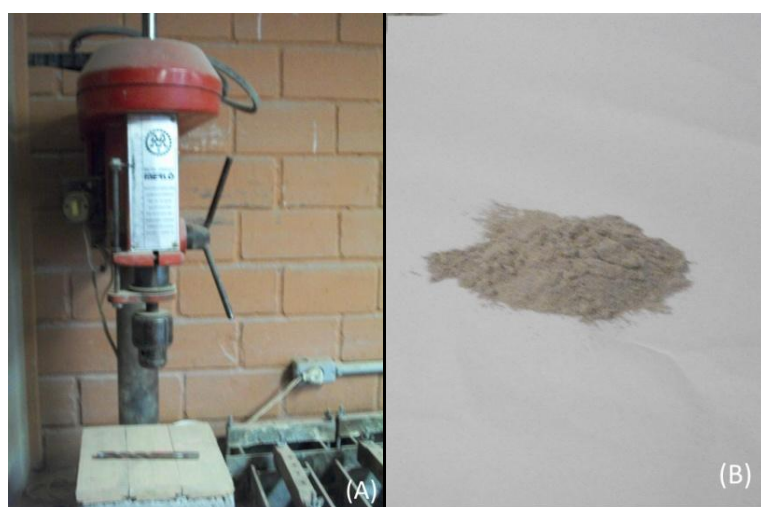
Figura 3.9 – (A) Furadeira utilizada na extração do pó. (B) Pó extraído para ensaio do teor de hidróxido de cálcio
