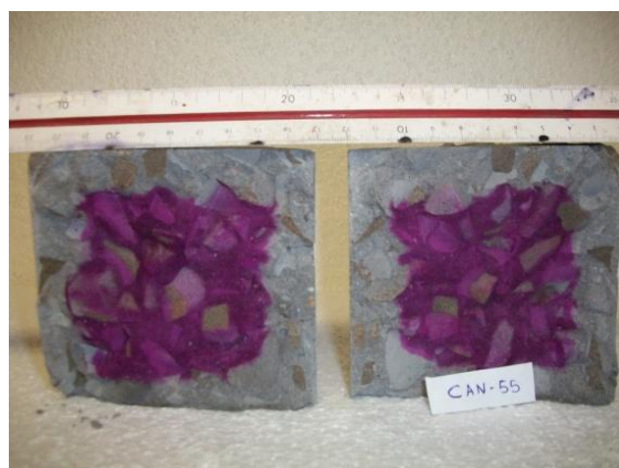
Figura 2.8 - Corpo de prova após aspersão da solução de fenolfetaleína.
