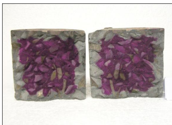
Figura 3.6 - Corpo de prova com a aspersão de fenolftaleína.
