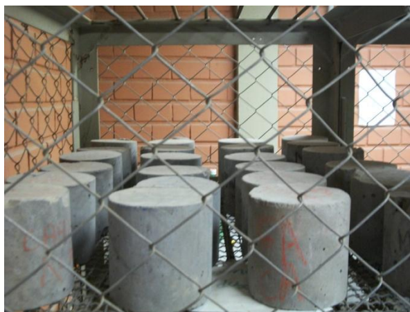
Figura 3.5 - Acondicionamento dos corpos de prova com 14 anos de idade.
