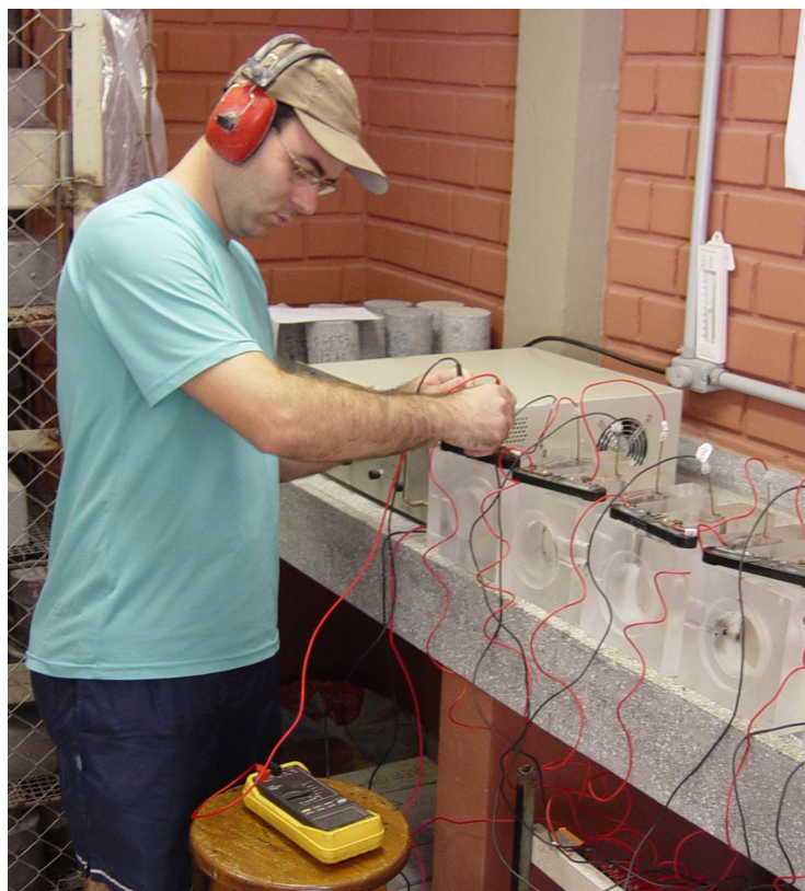
Figura 3.12 – Ensaio acelerado de penetração de cloretos
