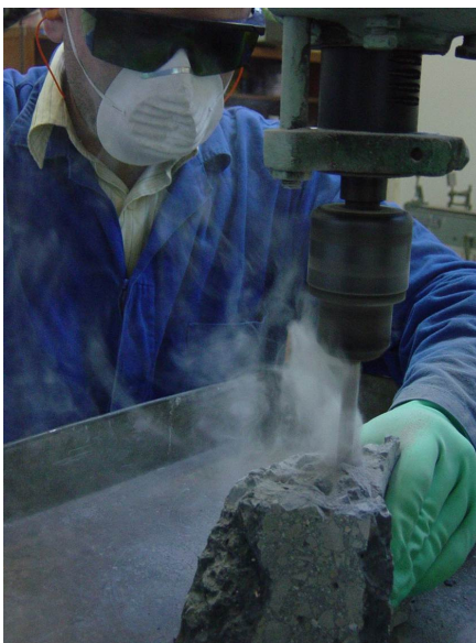
Figura 3.14 – Retirada do pó de concreto para o ensaio de água quimicamente combinada
