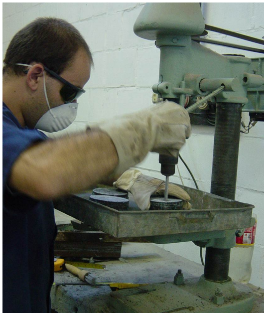
Figura 3.13 – Retirada do pó de concreto a profundidade de 1,50 cm para o ensaio de cloretos retidos
