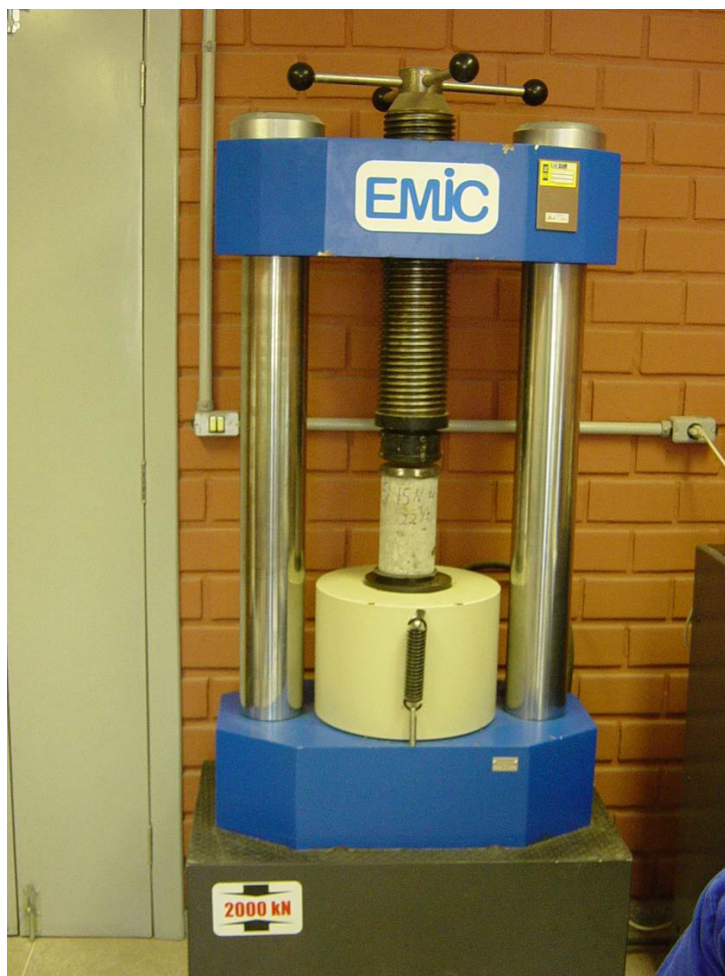
Figura 3.8 – Rompimento do corpo-de-prova
