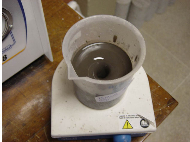
Figura 3.15 – Paralisação das reações de hidratação através do agitador eletromagnético
