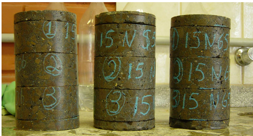
Figura 3.9 – Corpos de prova cortados (10 x 20 cm) para o ensaio de penetração acelerada de cloretos segundo a ASTM C 1202:2005
