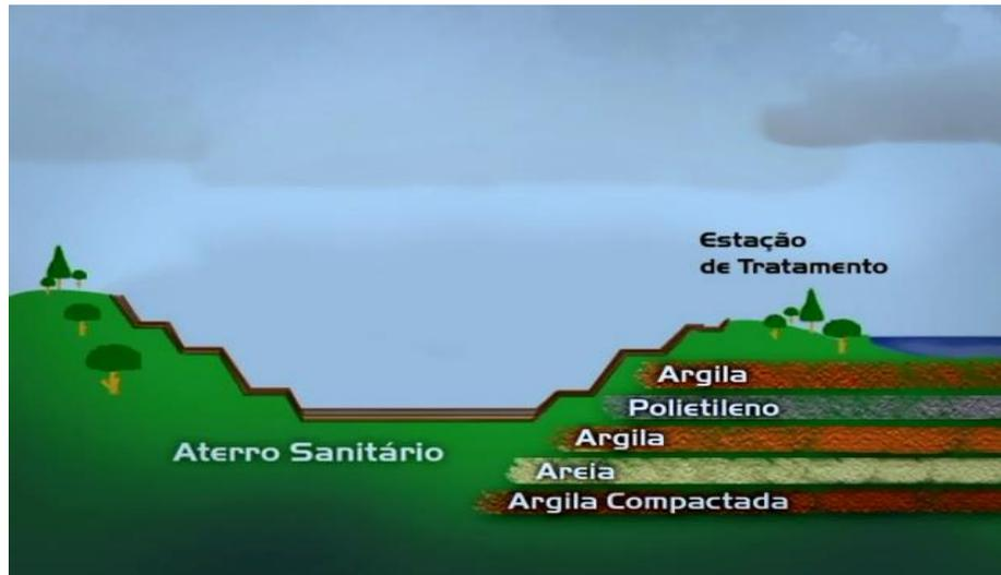
Figura 3.4 – Camadas de impermeabilização e proteção do solo
