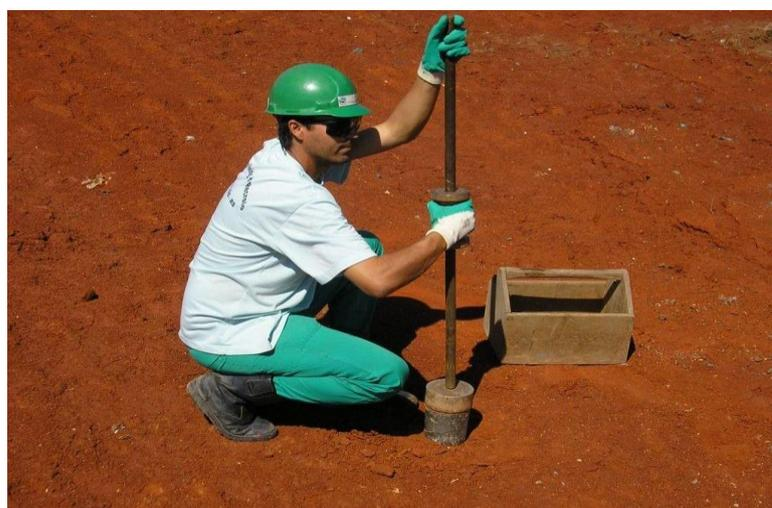
Figura 3.6 – Controle tecnológico das camadas compactadas de argila.
