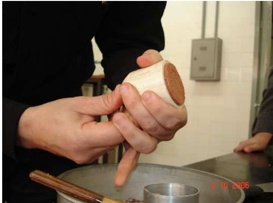
Figura 3.10 – Redução da altura da amostra no ensaio de perda de massa por imersão modificado
