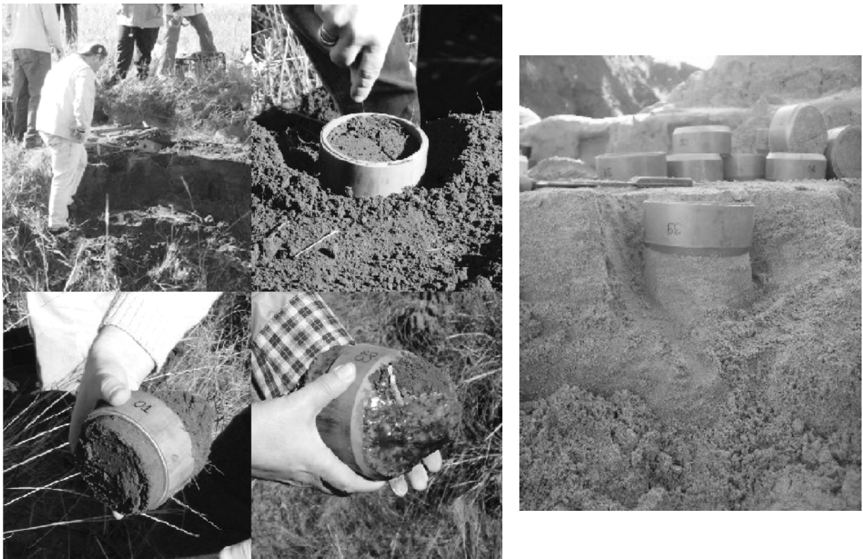
Figura 3.2 – Coleta de amostras indeformadas do horizonte B pedológico e do arenito (TATTO, 2007)
