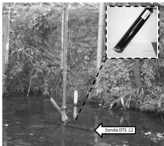
Figura 34 - Localização da sonda do turbidímetro na estação MD IV.
