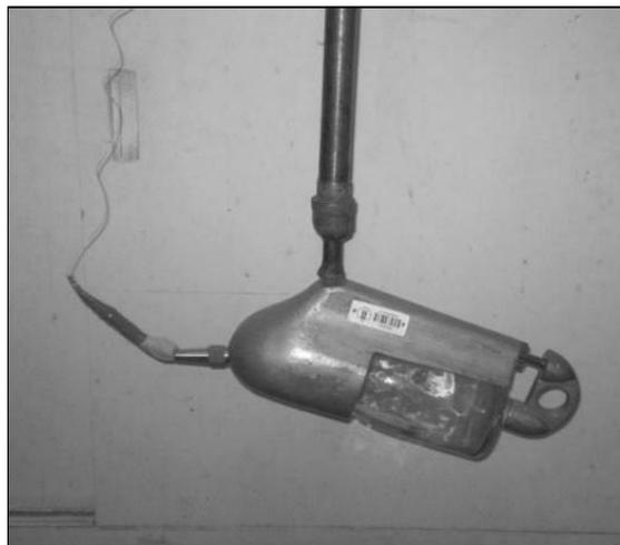
Figura 22 - Amostrador AMS 1 e a obstrução adaptada no bico.
