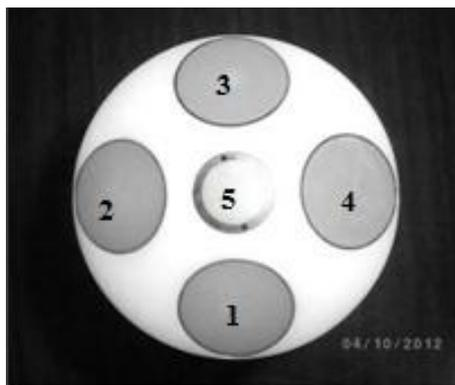
Figura 28 – Transdutores do equipamento com numeração do nº 1 a 4 referem-se os transdutores inclinados a 25° e o nº 5 ao feixe acústico vertical.
