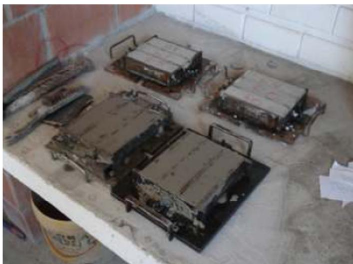
Figura 3.3 – Moldagem dos corpos-de-prova prismáticos de argamassa.
