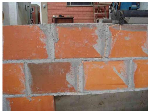
Figura 4.4 – Modo de ruptura do modelo VL4.
