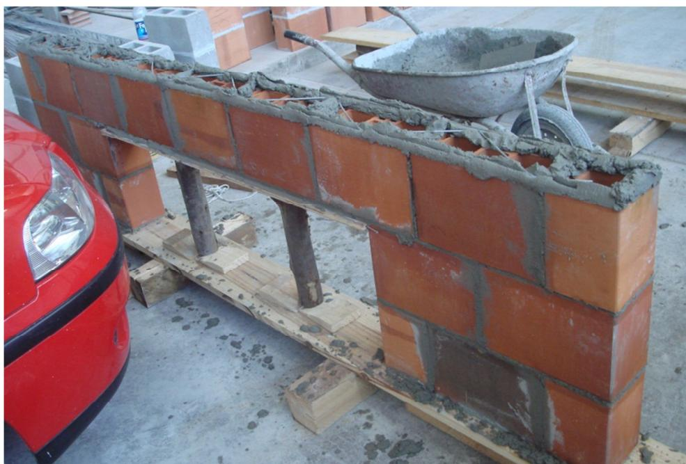
Figura 3.9 – Execução da segunda fiada sobre o vão do modelo VL.
