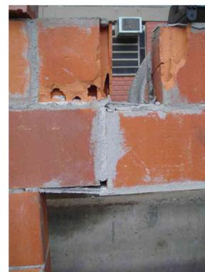
Figura 4.2 – Modo de ruptura do modelo VL2.
