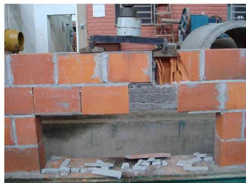
Figura 4.15 – Modo de ruptura do modelo VGL5.
