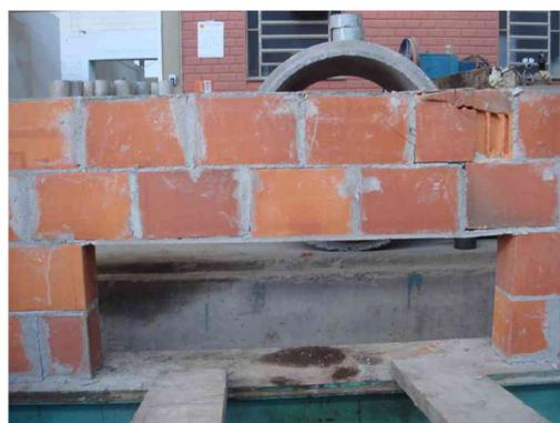
Figura 4.7– Modo de ruptura do modelo VLT2.
