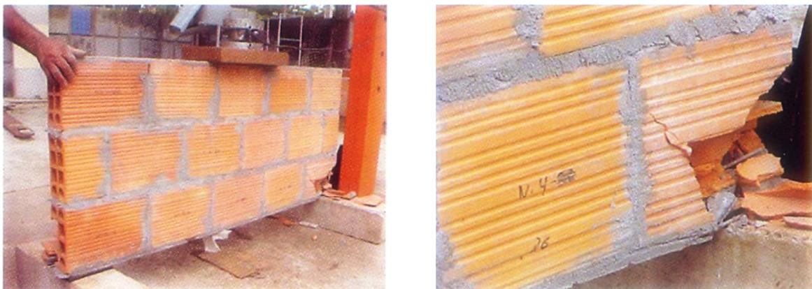
Figura 2.19 – Fissuras observadas na amostra 04.
