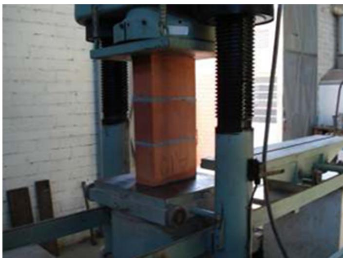
Figura 3.6 – Ensaio de compressão dos prismas por compressão.
