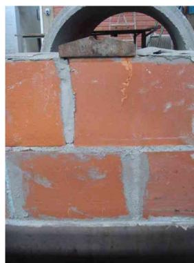
Figura 4.12 – Modo de ruptura do modelo VGL2.
