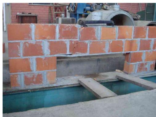
Figura 4.10 – Modo de ruptura do modelo VLT5.
