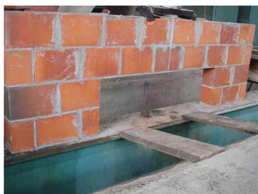
Figura 4.8 – Modo de ruptura do modelo VLT3.
