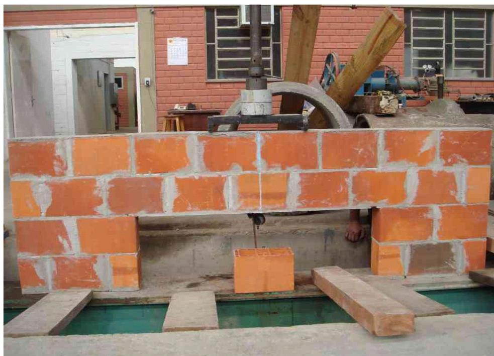
Figura 3.20 – Esquema geral do ensaio de ruptura das vergas.
