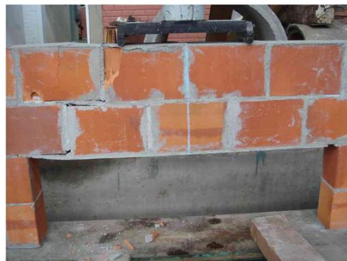
Figura 4.1 – Modo de ruptura do modelo VL1.
