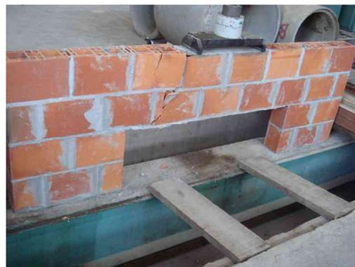
Figura 4.9 – Modo de ruptura do modelo VLT4.
