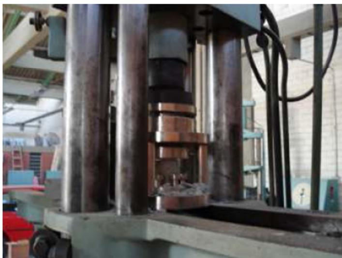
Figura 3.5 – Ensaio de ruptura por compressão axial dos corpos-de-prova de argamassa.
