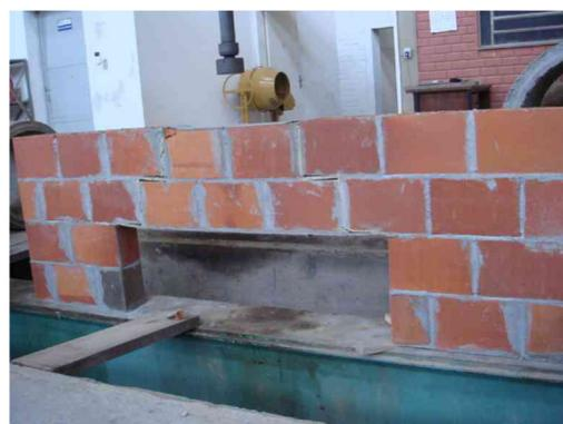
Figura 4.5 – Modo de ruptura do modelo VL5.
