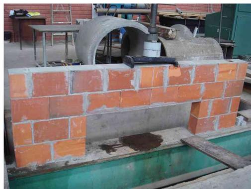
Figura 4.11 – Modo de ruptura do modelo VGL1.
