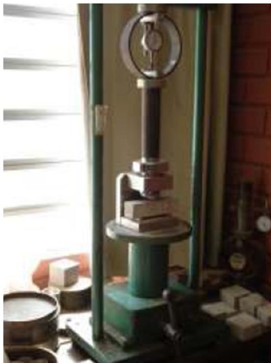
Figura 3.4 – Ensaio de ruptura por tração na flexão dos corpos-de-prova de argamassa.
