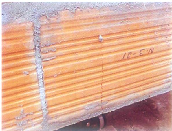
Figura 2.13 – Fissuração observada no ensaio da amostra 01.
