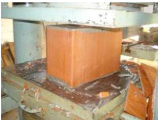
Figura 3.2 – Ensaio de ruptura à compressão axial dos blocos.
