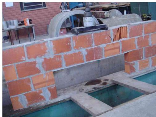
Figura 4.6 – Modo de ruptura do modelo VLT1.
