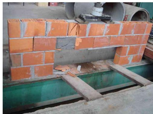
Figura 4.14 – Modo de ruptura do modelo VGL4.
