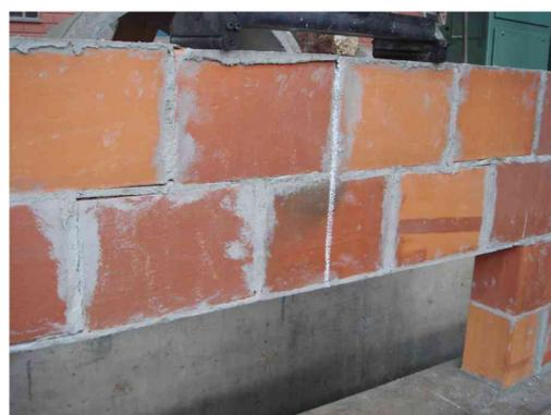
Figura 4.3 – Modo de ruptura do modelo VL3.
