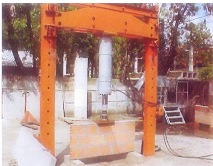
Figura 2.10 – Ensaio de ruptura das pequenas paredes.
