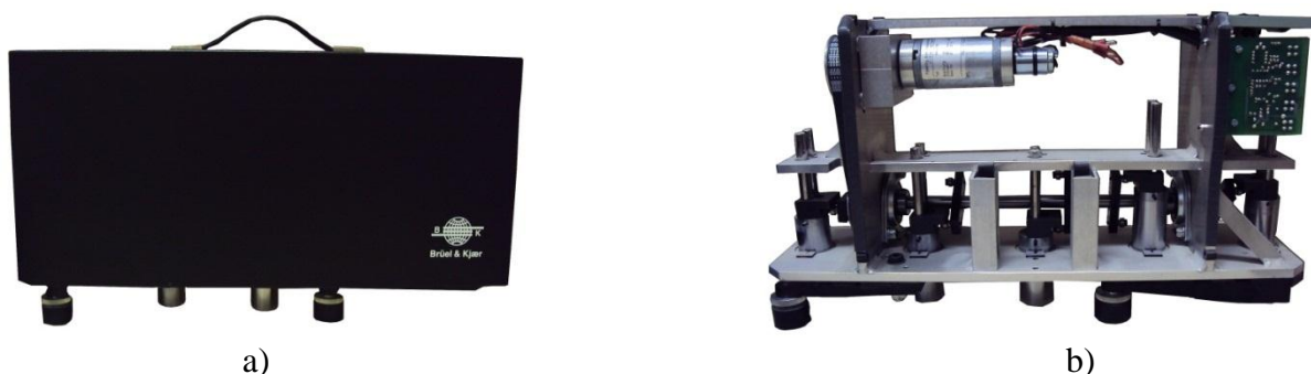
Figura 25 - Máquina de Impacto Padrão: a) com a proteção e b) sem a proteção.
