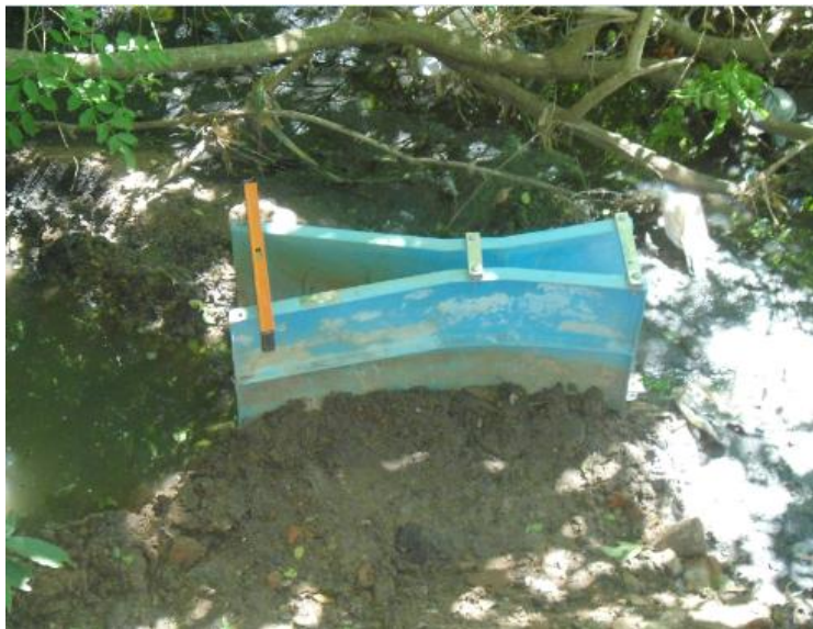
Figura 22 - Calha Parshall para medição de vazão.
