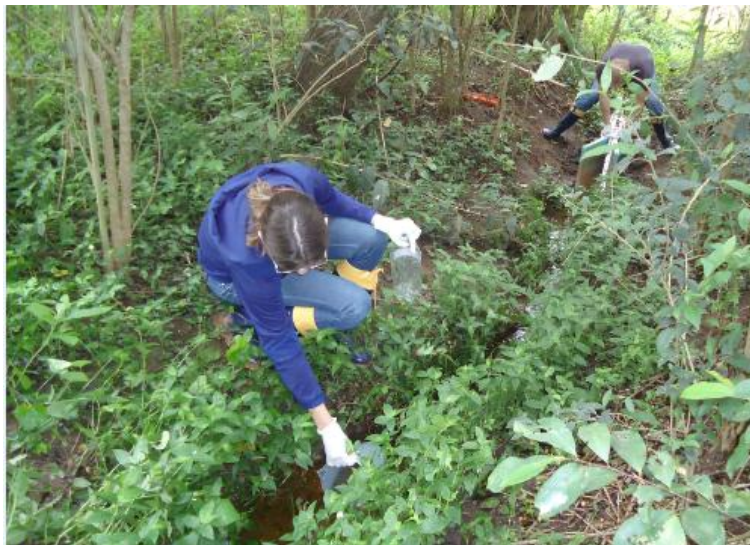
Figura 20 - Coleta de amostra de efluente e determinação da vazão no ponto CDE.
