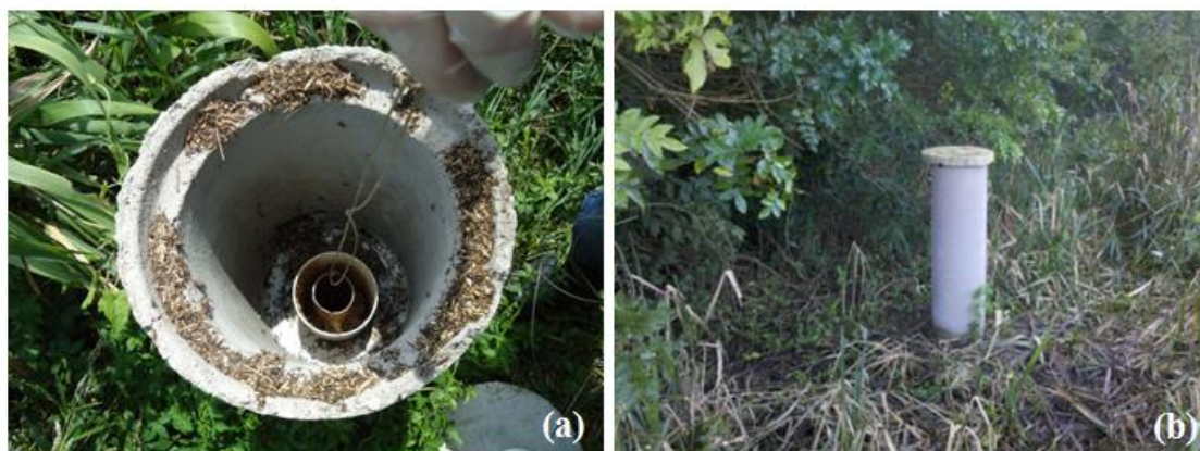
Figura 19 - Poços intermediários para coleta de água subterrânea PM-01(a) e PM-02 (b).
