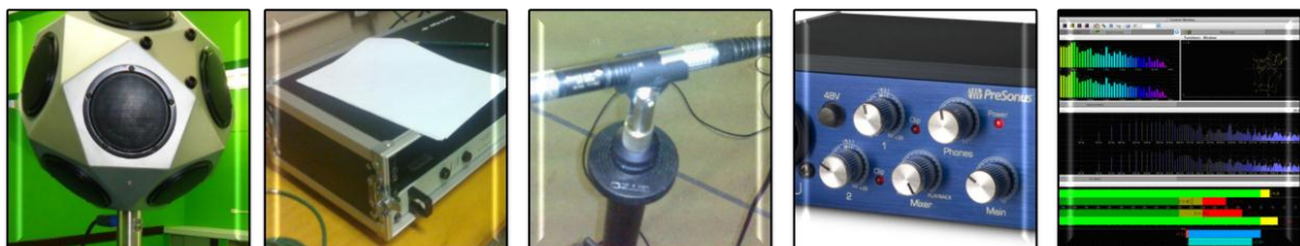
Figura 4.11 – Conforme a sequência apresentada: fonte sonora dodecaédrica omnidirecional tipo 4292; amplificador de potência tipo 2716, medidor de nível de pressão sonora tipo 2270; microfone de precisão para incidência aleatória tipo 4189, calibrador acústico (94 dB, ref. 20 \mu Pa, para 1.000 Hz); placa de som Presonus; programa computacional Dirac para aquisição e análise de dados.
