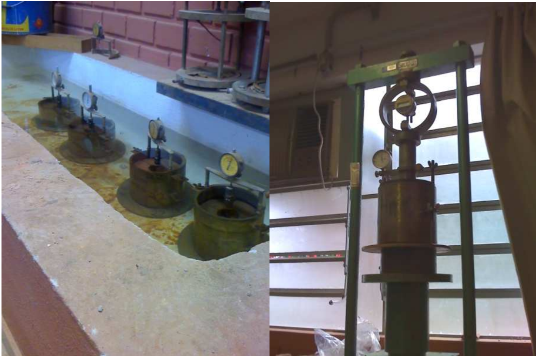
Figura 3.9 – Ensaio de Índice de Suporte Califórnia.
