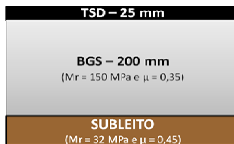
Figura 3.14 – Estrutura Pavimento com BGS.
