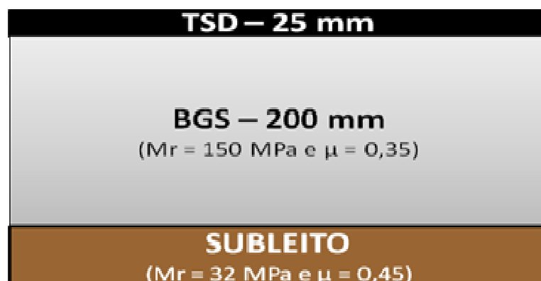
Figura 4.16 – Estrutura Pavimento com BGS.
