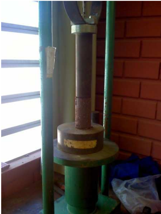
Figura 3.10 – Ensaio de Resistência à Compressão Simples
