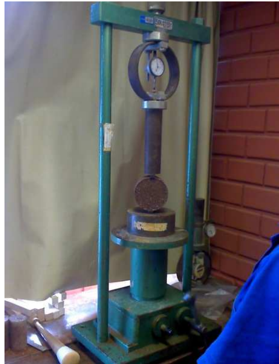
Figura 3.11 – Ensaio de Resistência à Compressão Diametral
