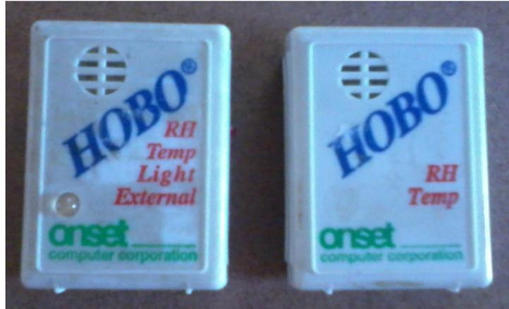
Figura 26 – Aparelho de medição “hobo”: medição externa e interna.
