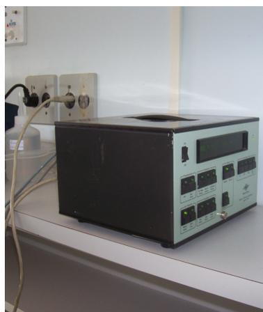
Figura 33 – Analisador Climático Interno (Bruel & Kjaer tipo 1213).
