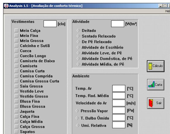
Figura 17 – Tela para entrada de dados para análise do conforto.
