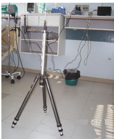
Figura 32 – Tripé com sensores conectados ao analisador.
