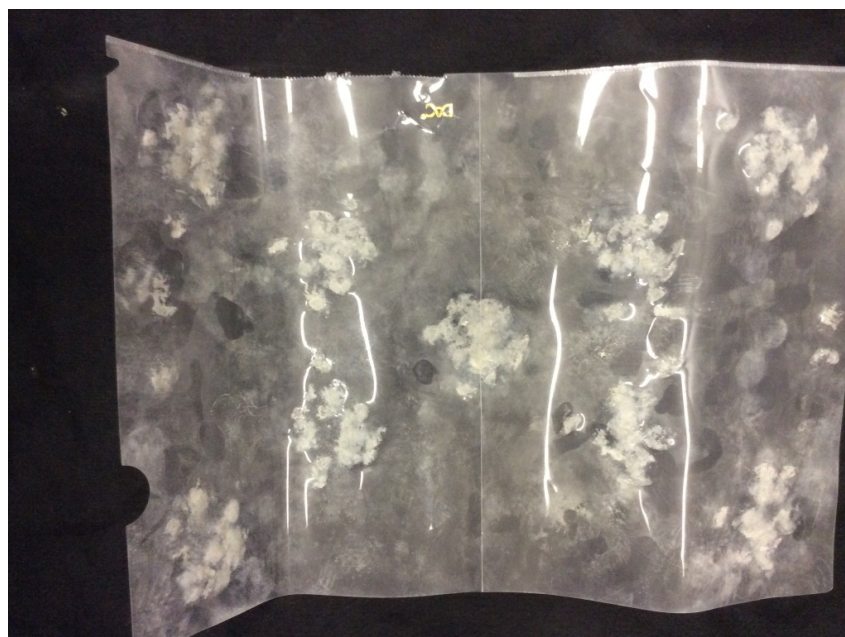
Figura 3.8.: Desgaste da capa plástica após as medições com o contrapiso de concreto.
