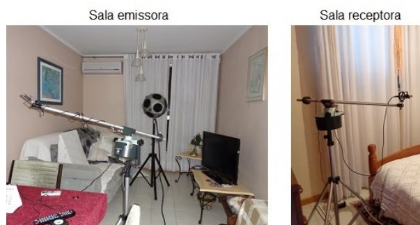
Figura 3.16.: Medição da PT, ao ruído aéreo.
