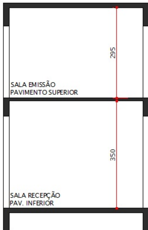
Figura 3.3.: Corte - Câmaras de impacto da UFSM.
