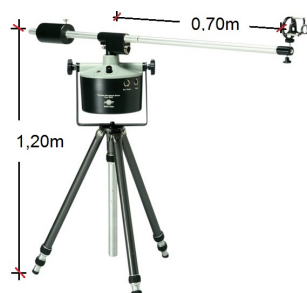
Figura 3.15.: Altura e raio de varredura, para o Rotating Boom .
