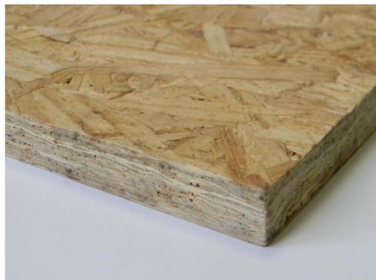
Figura 35 – Painel OSB 9,5 mm de espessura
