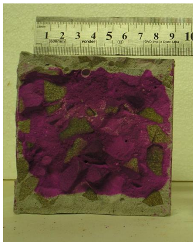
Figura 14 - Concreto carbonatado com fenolftaleína
