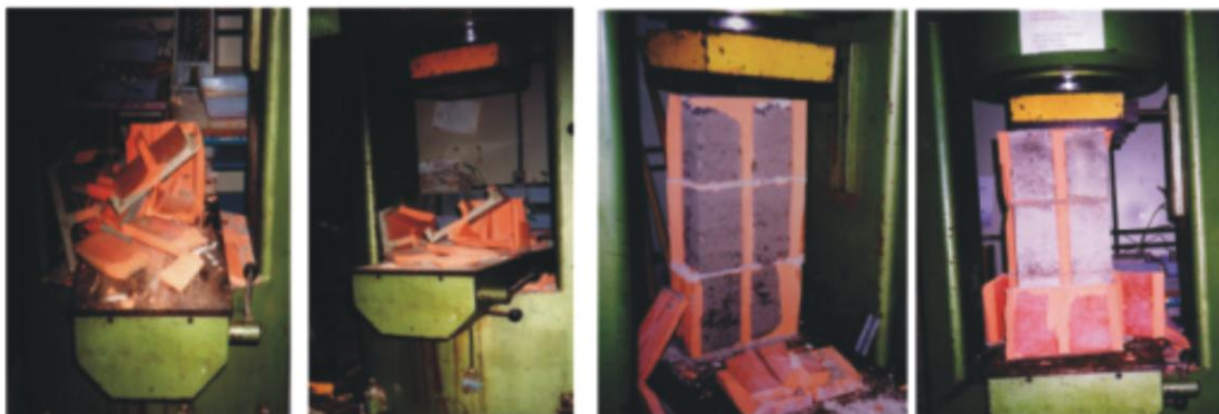
Ruptura prisma não-grauteado
