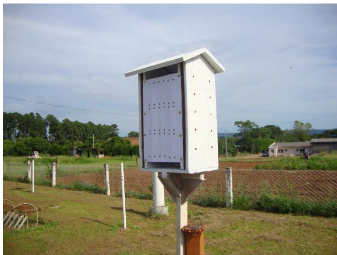
Figura 20 – Miniabrigo instalado próximo à estação do INMET, no Campus da UFSM. Ponto 01 – UFSM-INMET da pesquisa.
