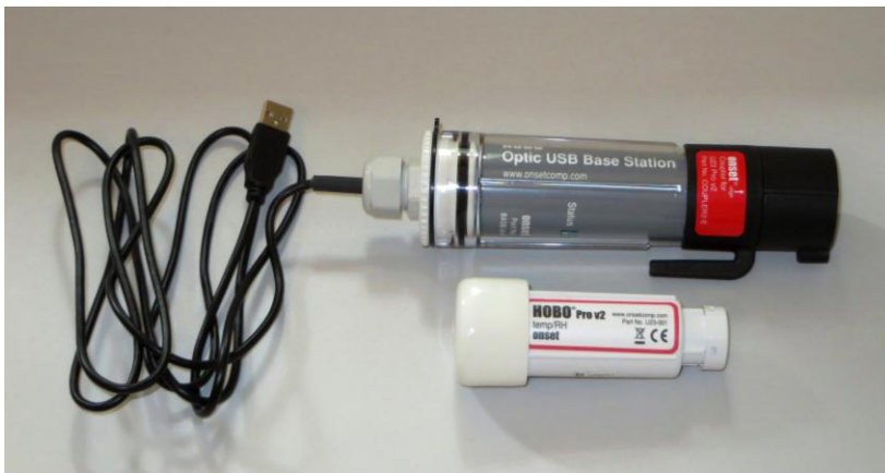
Figura 19 – Base ótica USB e HOBO U23-001 para leitura e coleta dos dados de temperatura e umidade relativa do ar.
