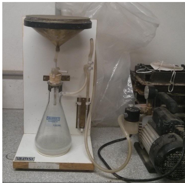
Figura 16 – Funil de Büchner, equipamento utilizado no ensaio de retenção de água
