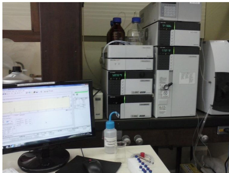
Figura 2 - Cromatógrafo a líquido de alta eficiência Shimadzu modelo LC-20AD acoplado a detector por UV-VIS modelo SPD-20A. Laboratório de Análises Ambientais, Instituto de Química da Universidade Federal do Rio Grande do Sul.
