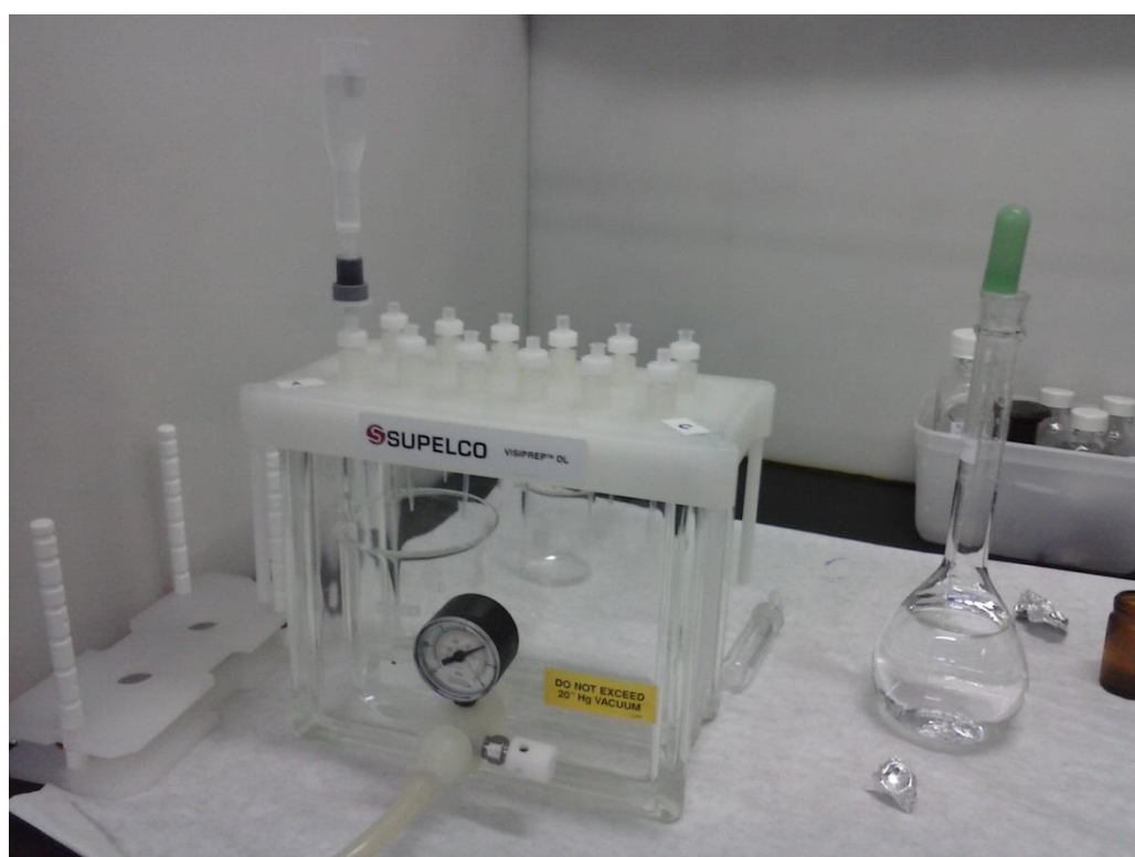
Figura 2 – Sistema utilizado para etapa de extração em fase sólida: cartucho de carvão ativo Waters, acoplado em manifold equipado com bomba de vácuo.
