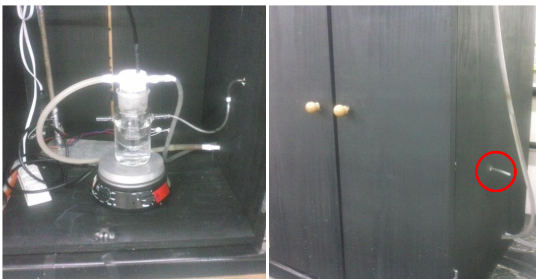
Figura 4 – Fotorreator de lâmpada resfriada de bancada com sistema de resfriamento e agitação. À direita, estrutura para isolamento da radiação durante a utilização do fotorreator, com detalhe para o ponto de coleta via seringa.
