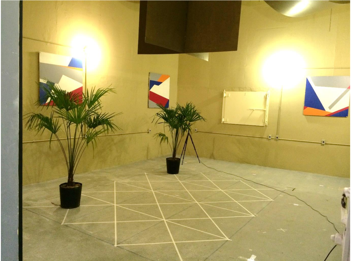
Figura 3.3 – Imagem interna da câmara reverberante do LEAC – UFSM Fonte: Autor
