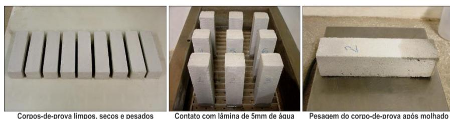
Figura 47 – Processo de ensaio de absorção de água por capilaridade
