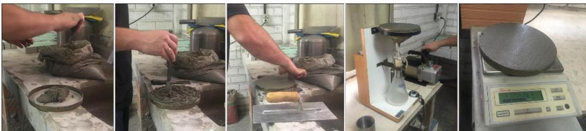
Figura 46 – Ensaio de retenção de água
