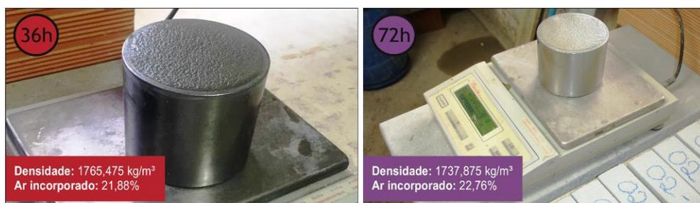
Figura 42 – Ensaio de densidade e teor de ar incorporado
