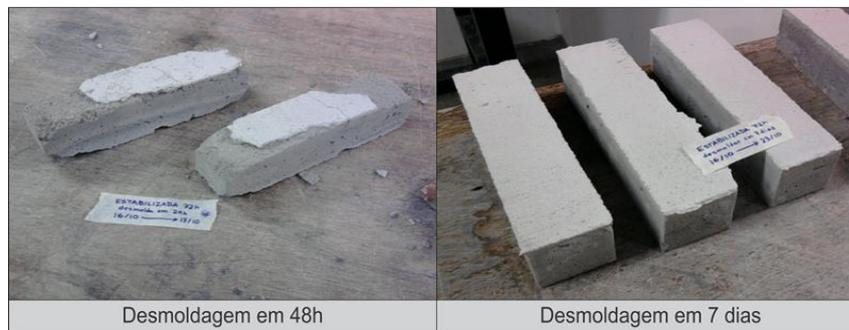
Figura 27 – Diferença entre amostras desmoldadas conforme a norma e após 7 dias
