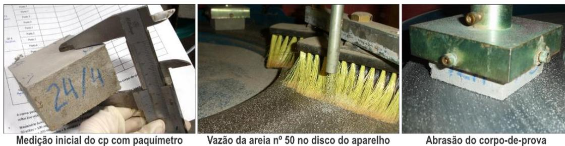
Figura 51 – Ensaio de desgaste por abrasão
