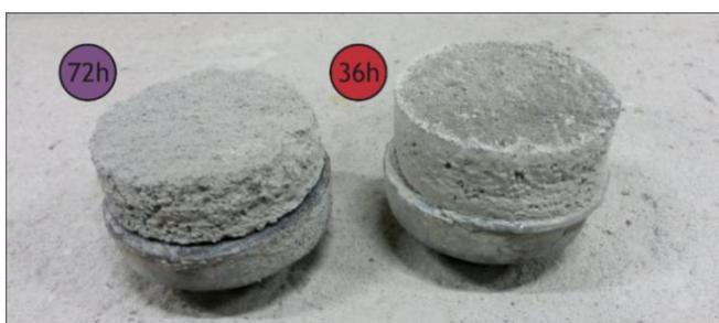
Figura 68 – Amostras extraídas das placas de resistência de aderência
