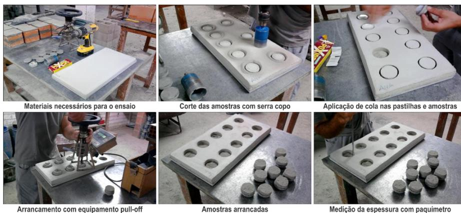
Figura 65 – Ensaio de resistência de aderência
