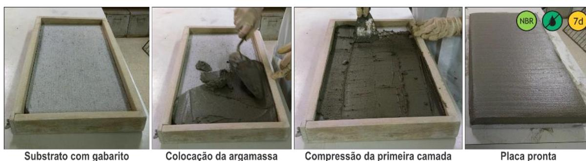
Figura 36 – Processo de moldagem das placas de aderência
