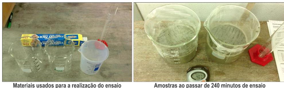
Figura 44 – Ensaio de exsudação de água
