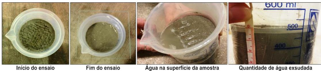
Figura 43 – Ensaio preliminar de exsudação de água
