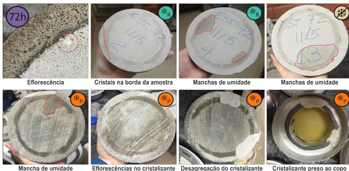
Figura 64 – Inspeção visual das amostras de 72h ao fim do ensaio de permeabilidade
