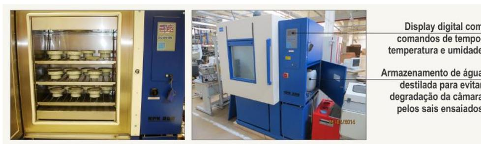
Figura 61 – Câmara climática com os copos usados no ensaio
