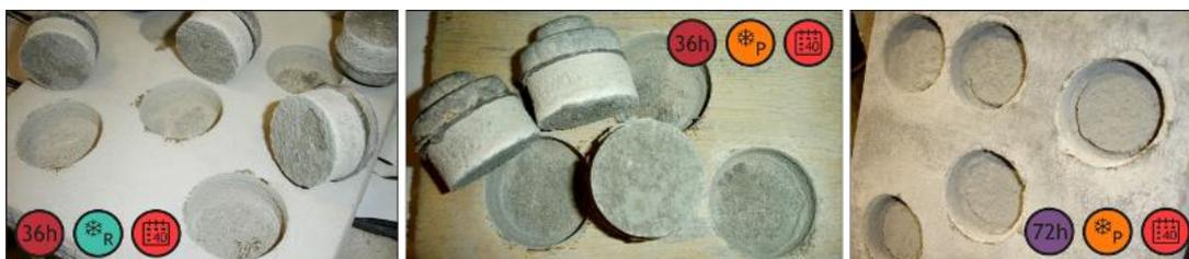
Figura 67 – Ensaio de aderência aos 40 dias, após aplicação de cristalizantes
