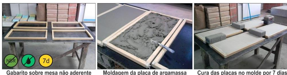
Figura 33 – Processo de moldagem das placas de argamassa de revestimento
