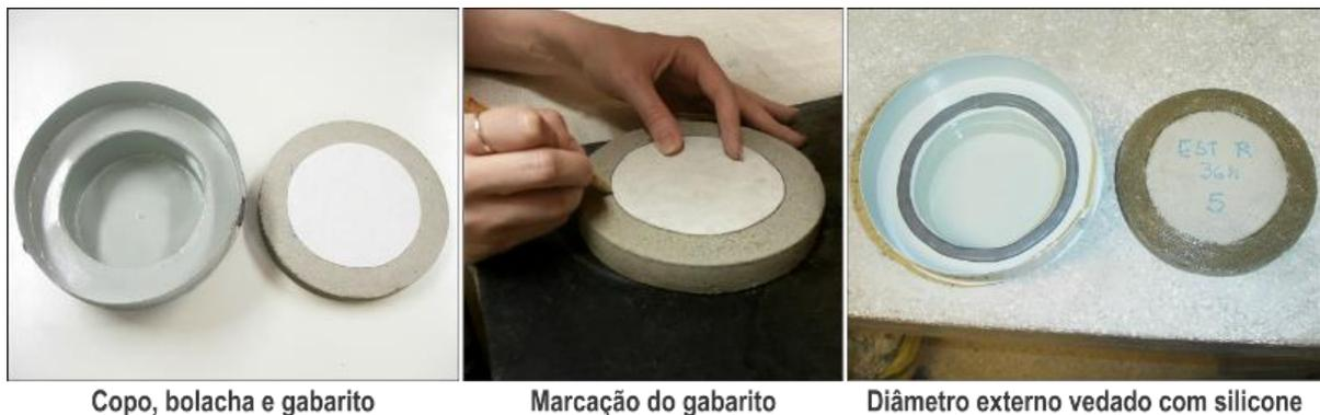
Figura 22 – Preparação da amostra para o ensaio de permeabilidade
