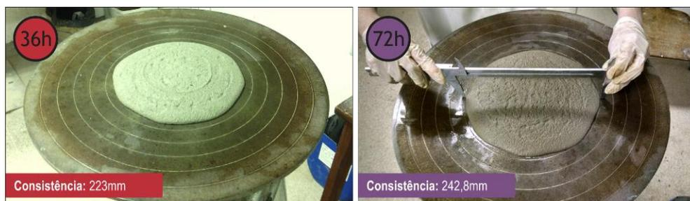
Figura 45 – Ensaio de índice de consistência
