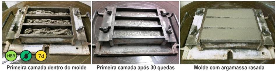
Figura 31 – Processo de moldagem dos corpos-de-prova prismáticos
