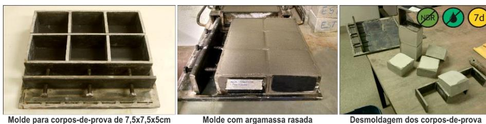
Figura 32 – Processo de moldagem dos corpos-de-prova para o ensaio de abrasão
