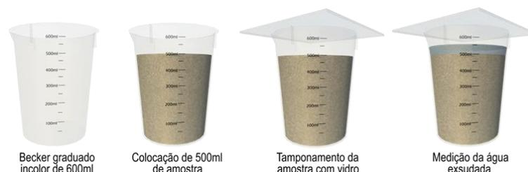
Figura 16 – Etapas do ensaio de exsudação de água conforme RILEM MR-6
