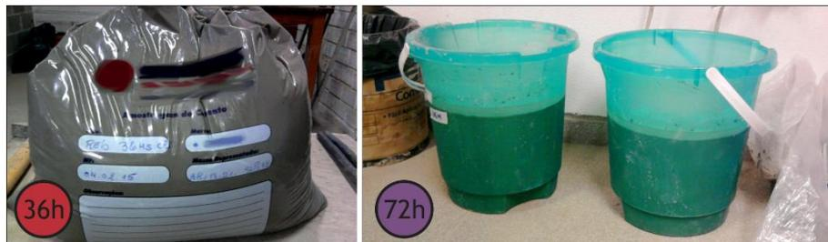
Figura 28 – Coleta e armazenamento das argamassas estabilizadas
