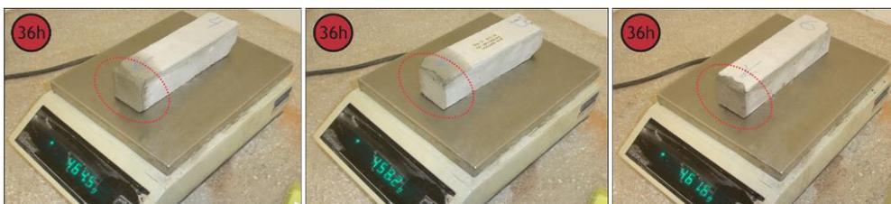
Figura 48 – Desagregação de parte da camada rasada
