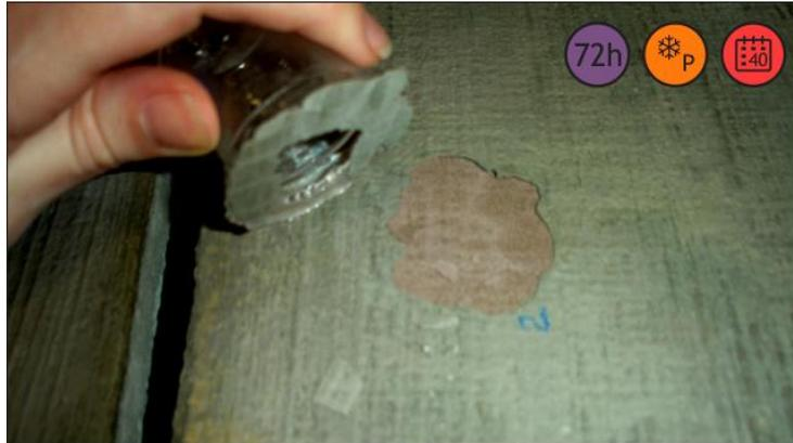
Figura 55 – Desagregação da camada de tratamento cristalizante
