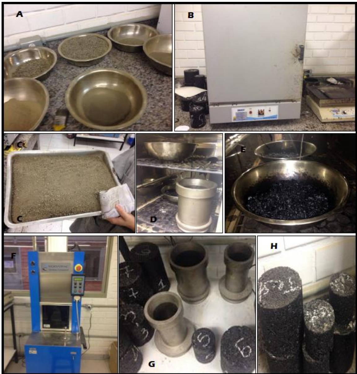
Figura 14: Etapas da preparação das misturas asfálticas. A: Separação granulométrica através do peneiramento. B: Estufa utilizada na secagem, aquecimento de moldes, envelhecimento da mistura e aquecimento do ligante. C: Material seco e aquecido para moldagem. D: Molde sendo aquecido e mistura asfáltica sendo envelhecida. E: Massa asfáltica em processo de envelhecimento na temperatura de compactação. F: Compactador Giratório – CGS. G: Moldes utilizados na compactação. H: CPs moldados no CGS.
