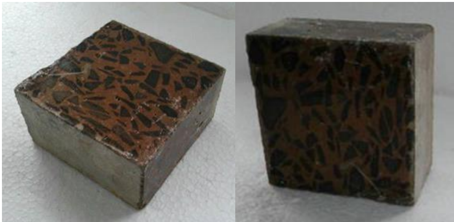
Figura 22 – Corpos de prova fatiados, preparados para imersão no tanque, com 4 faces impermeabilizadas com verniz
