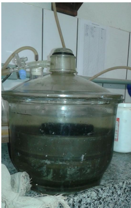
Figura 22 – Corpo de prova submetido ao vácuo no ensaio de Lottman
