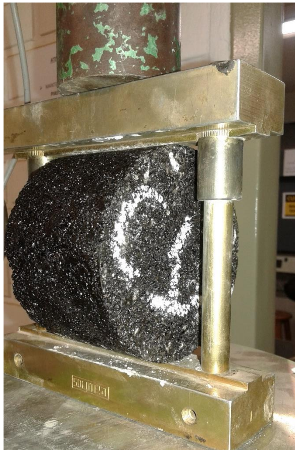
Figura 35 – Corpo-de-prova submetido ao ensaio de RT
