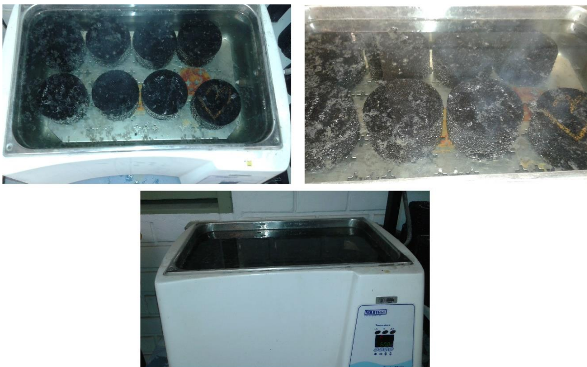
Figura 38 – Amostras imersas em banho de água destilada à temperatura de 60°C
