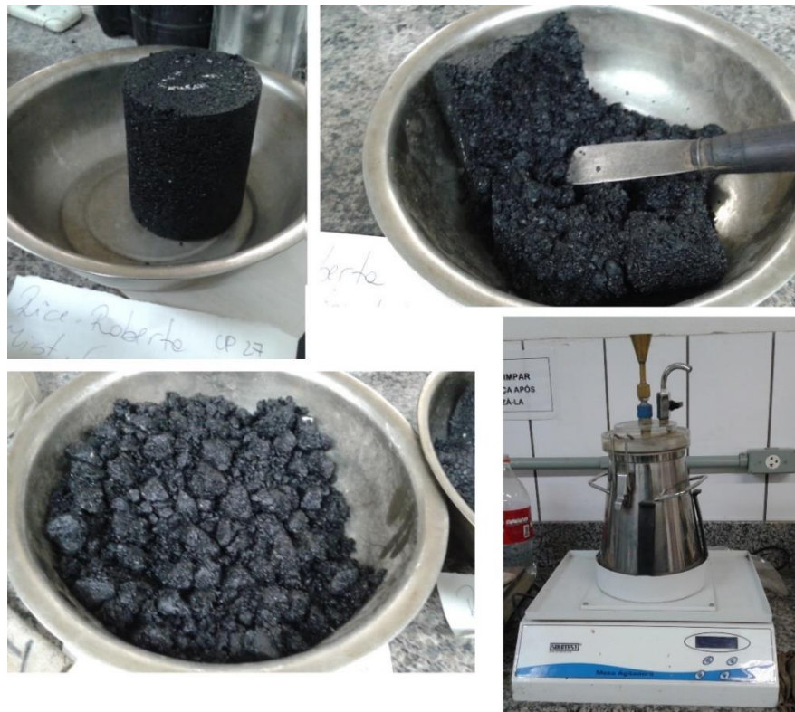
Figura 33 – Realização do ensaio de densidade da mistura através do método de Rice
