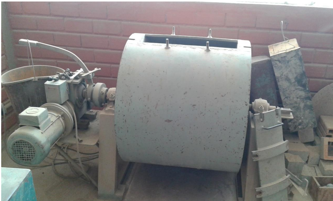
Figura 39 – Aparelho de abrasão Los Angeles do LMCC
