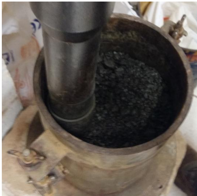
Figura 29- Amostra de Compactação sendo rasada
