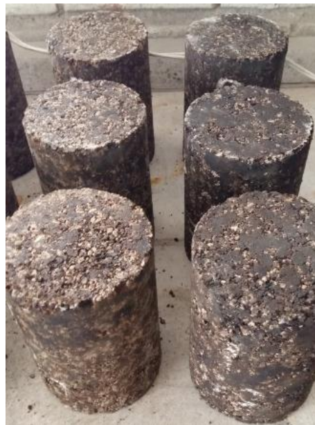
Figura 34 - Corpos de prova 10 cm x 15 cm
