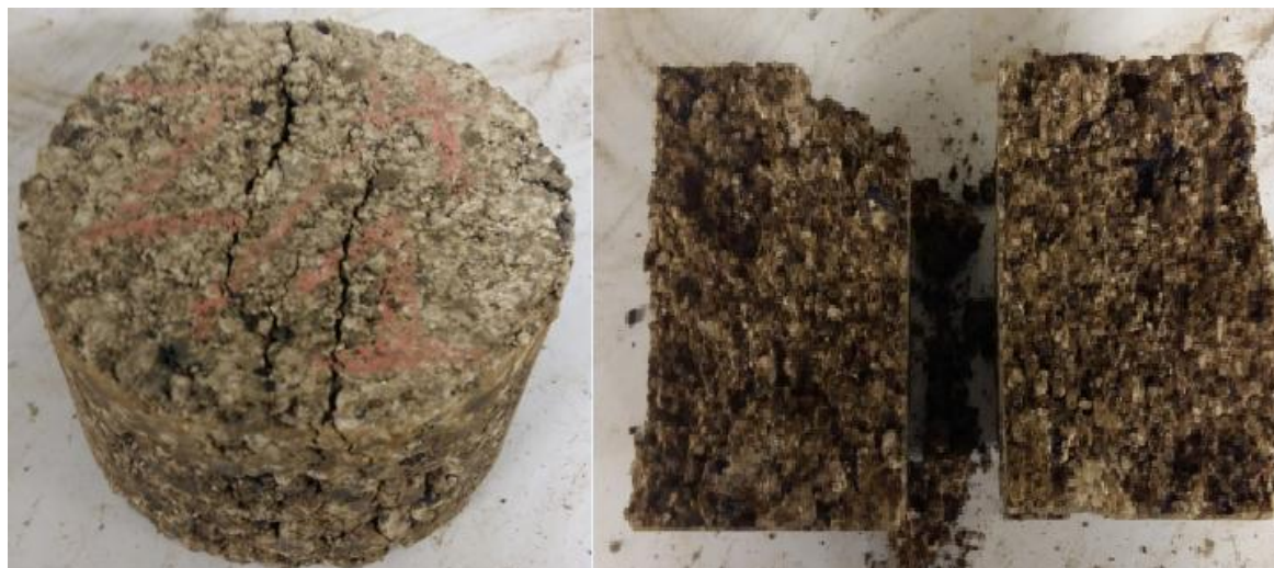
Figura 48- Amostra de RT rompida
