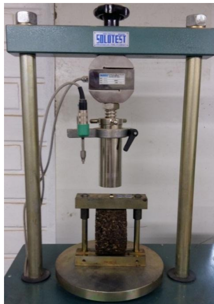
Figura 38 - Prensa pneumática com ensaio de RT
