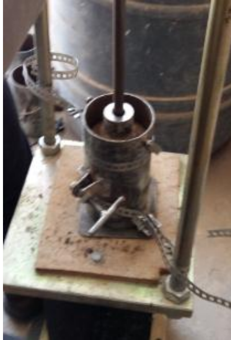
Figura 32- Amostra de 10cm x 20cm sendo compactada para ensaio de RCS
