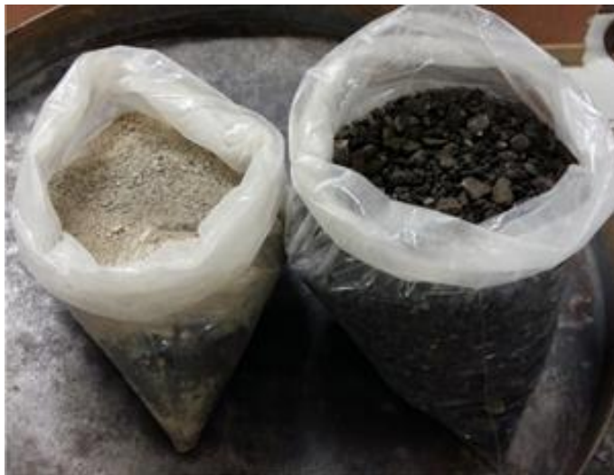
Figura 25- RAP e pó de pedra para confecção das misturas
