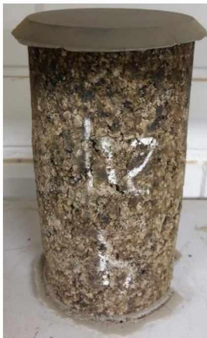
Figura 46 - Amostra rompida no ensaio de RCS
