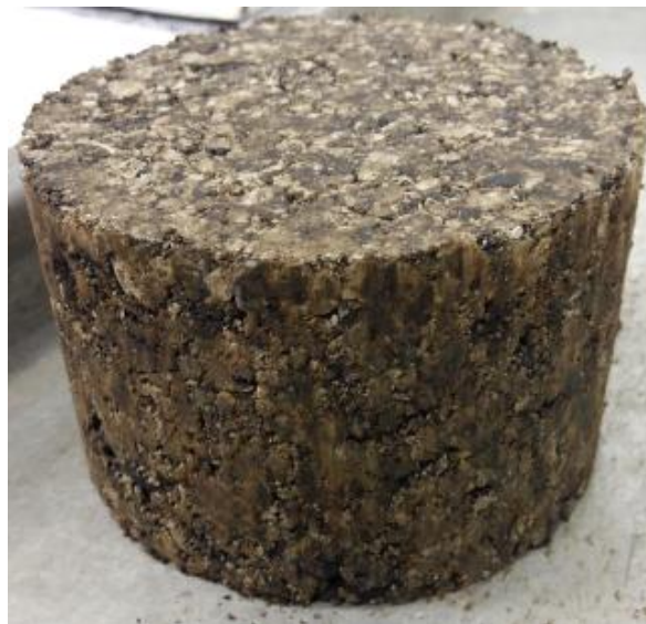
Figura 31- Amostra Marshall curada e desmoldada
