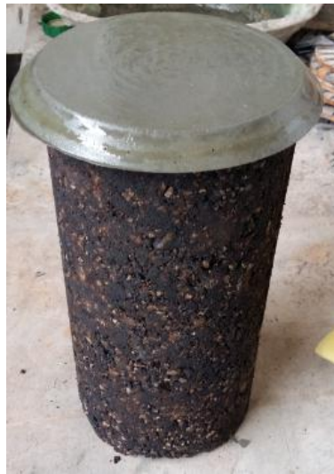
Figura 34 - Corpos de prova 10 cm x 15 cm
