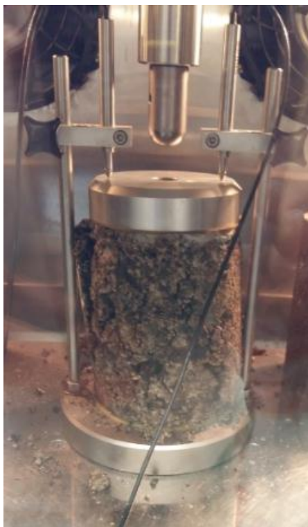
Figura 42 - Amostra rompida após a realização do ensaio de Flow Number
