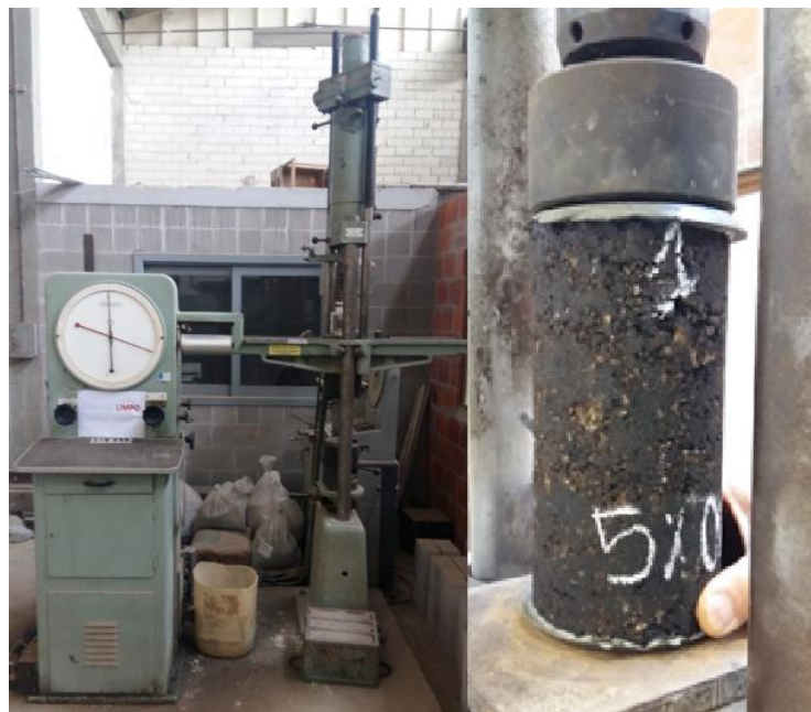
Figura 36 - Amostra capeada pronta para ser ensaiada e prensa de compressão
