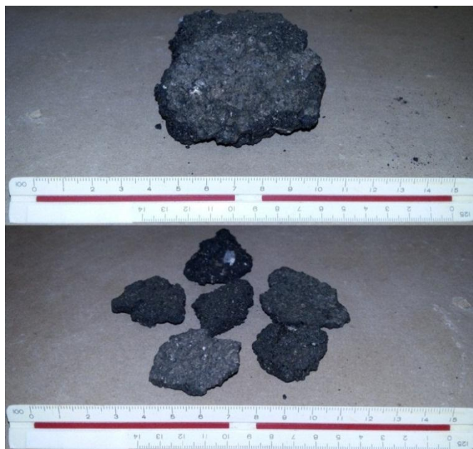
Figura 23 - Grumos retirados da amostra ensaiada em laboratório.
