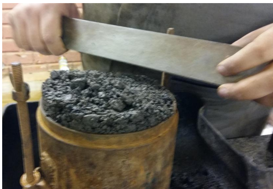
Figura 29- Amostra de Compactação sendo rasada
