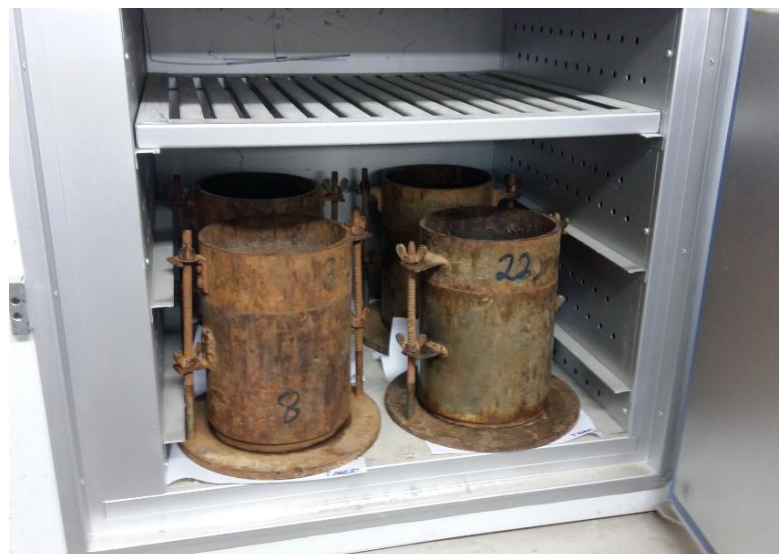
Figura 30- Amostra durante o processo de cura da mistura
