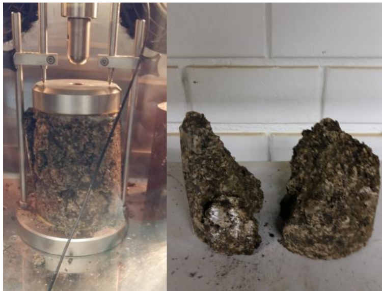
Figura 79- Amostra 2% 1% rompida no ensaio de FN
